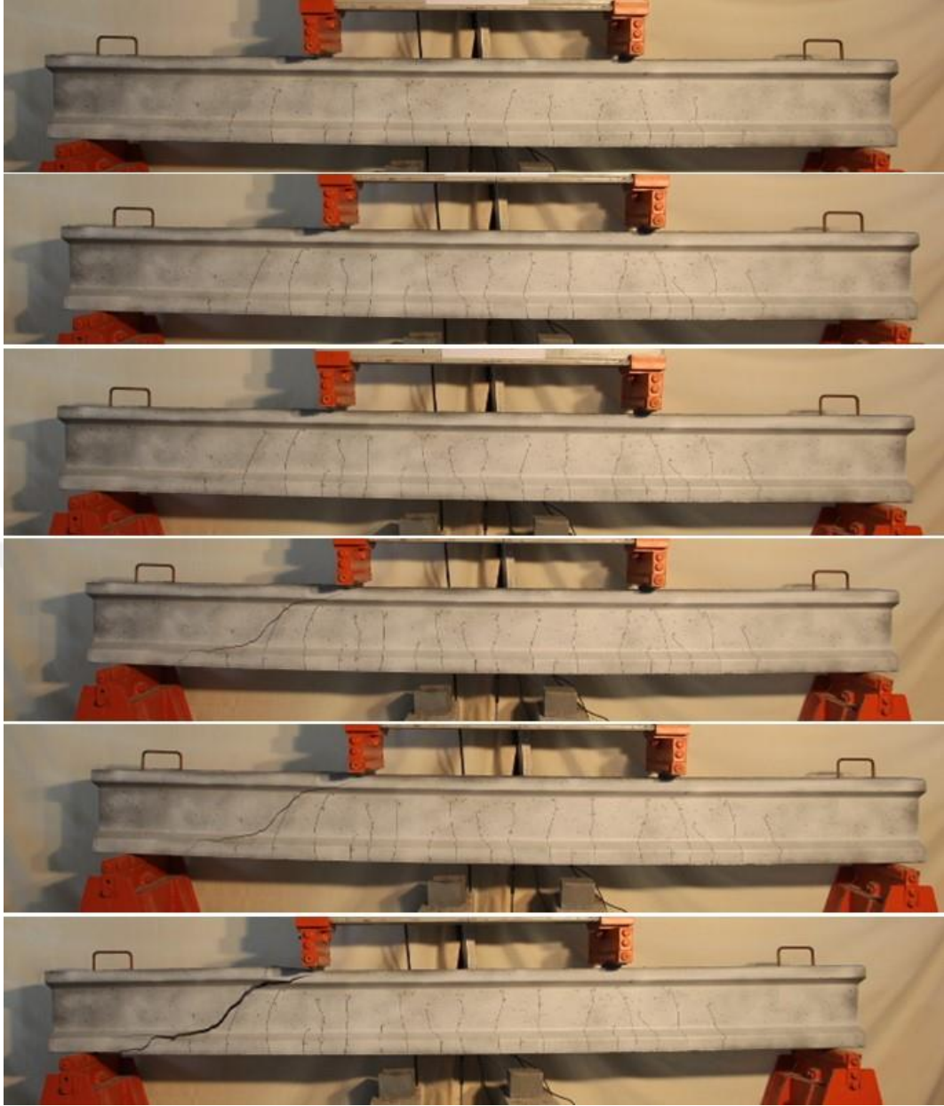
Şekil 3.7: K2 kirişinin çatlak davranışı ve kırılma şekli.
