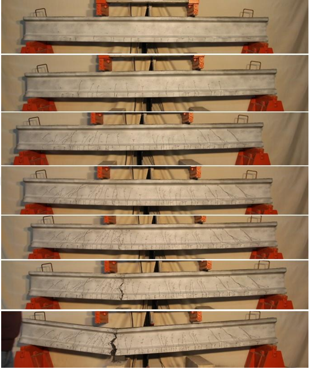
Şekil 3.15: K2-F kirişinin çatlak davranışı ve kırılma şekli.
