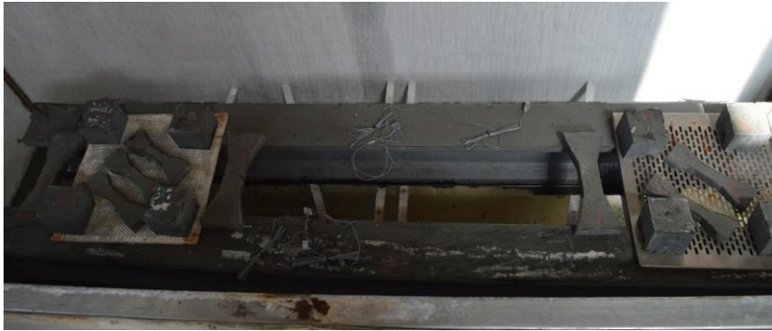
Şekil 2.12: Döküm sonrası plastik örtü ile sarılan test kirişi.
