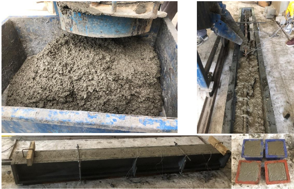
Şekil 2.11: Geleneksel beton içeren test kirişinin hazırlanması.
