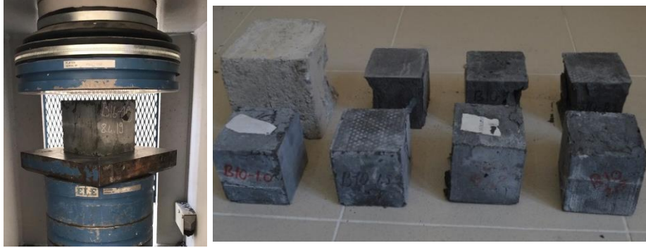
Şekil 2.19: Beton testi sonucu numunelerin kırılma şekilleri.
