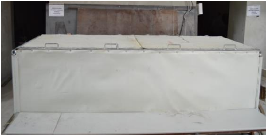
Şekil 2.13: Test kirişlerinin ve numunelerin kür kabindeki görüntüsü.
