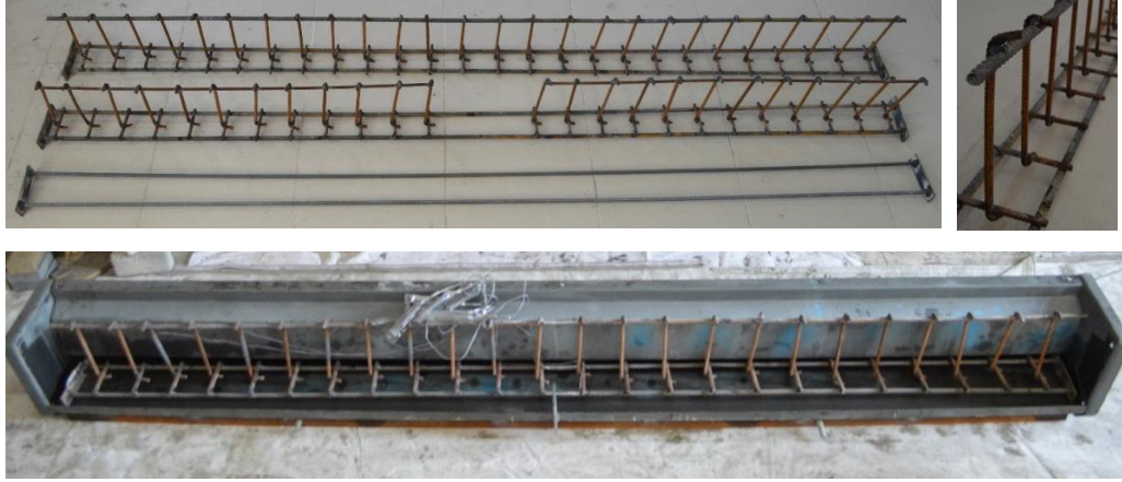
Şekil 2.6: Test kirişlerinde kullanılan çekme, basınç ve enine donatıları, donatının kalıp içindeki yerleşimi.
