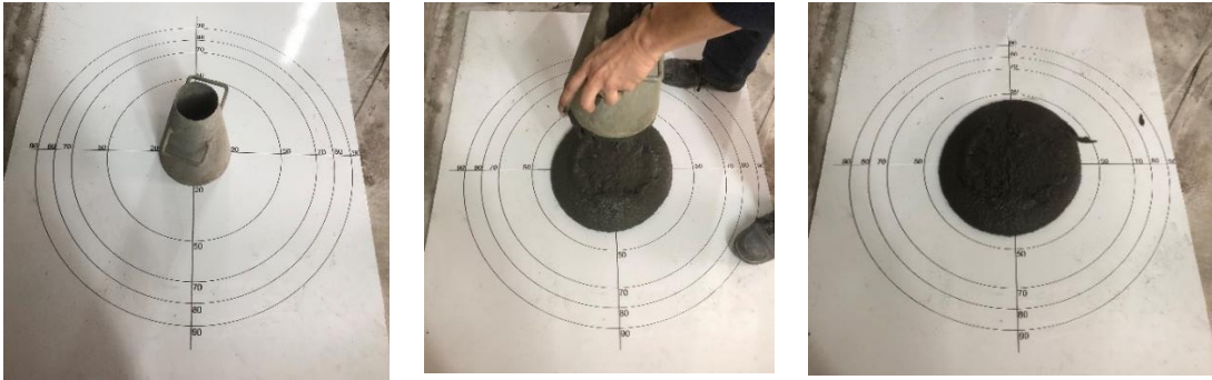
Şekil 2.14: Betonun yayılma süresinin ( T_{500} ) ve çapının belirlenmesi.
