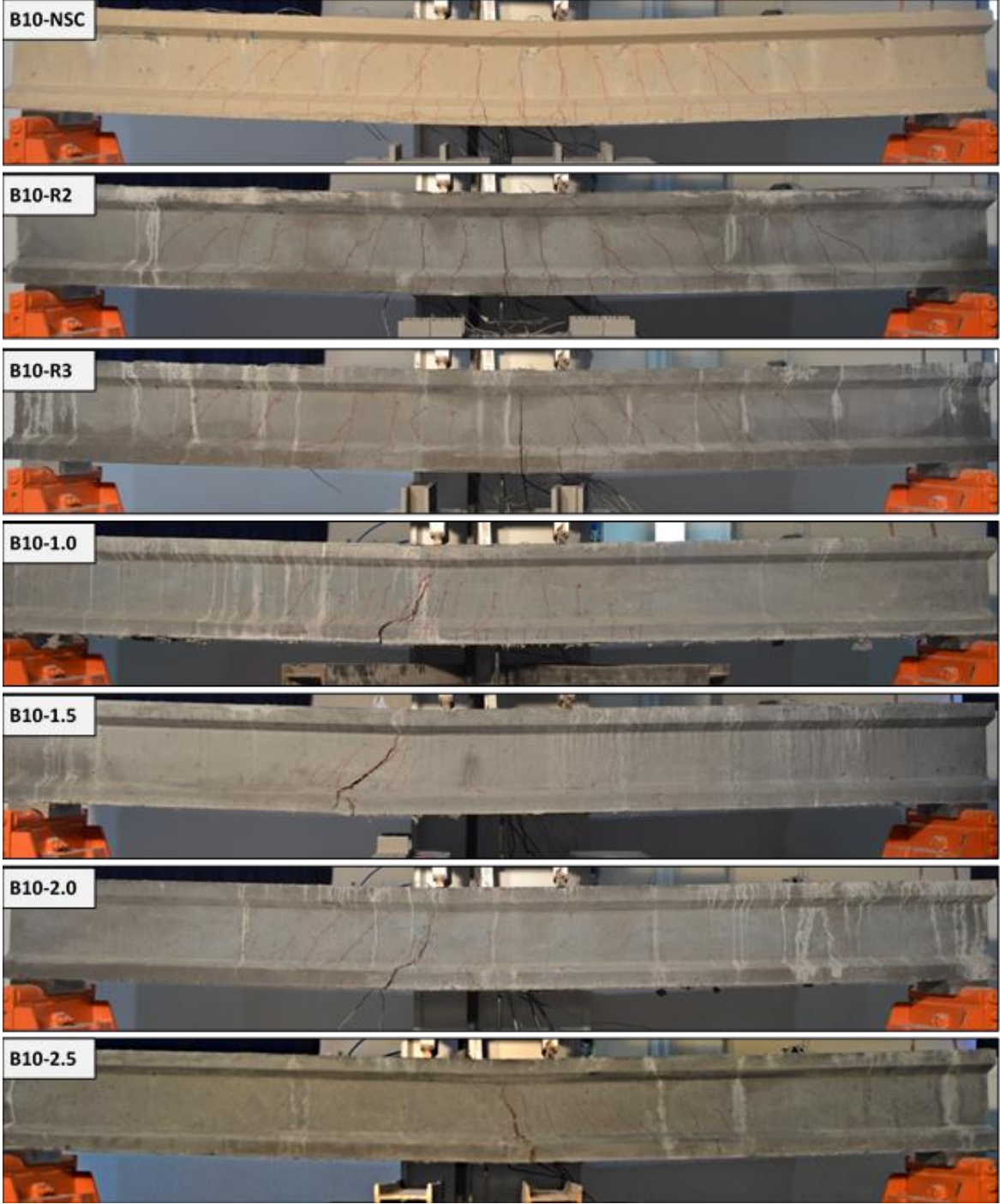
Şekil A.9: G1 Grubu kirişlerin L/100 deplasmanındaki çatlak dağılımları.
