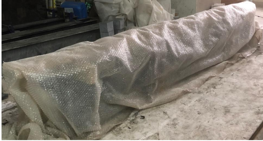
Şekil 2.12: Döküm sonrası plastik örtü ile sarılan test kirişi.
