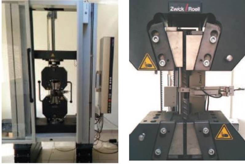
Şekil 2.22: Kiriş donatılarının çekme testi ile mekanik özelliklerinin belirlenmesi.
