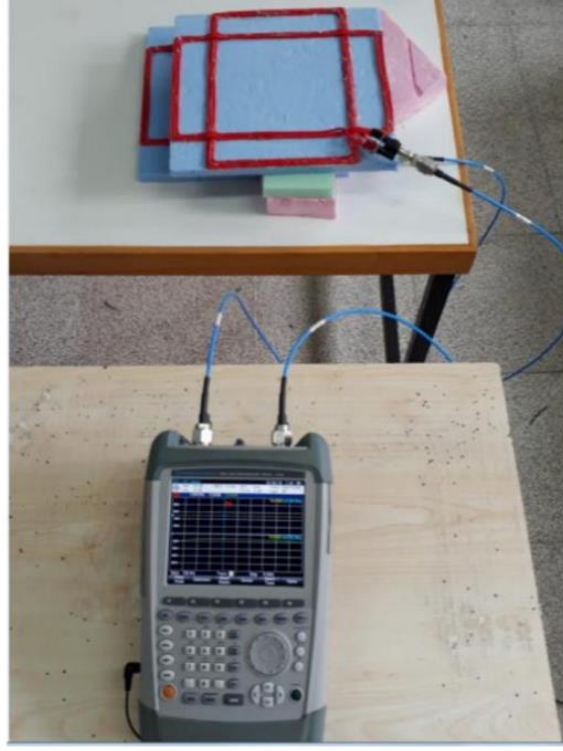
Şekil 3.7: Deney ortamında üretilen artı şekilli çevrim çifti ve ağ analizörü.
