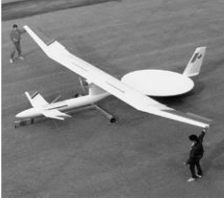
Şekil 1.5: SHARP firmasının mikrodalga enerjisi ile çalışan uçağı [8].
