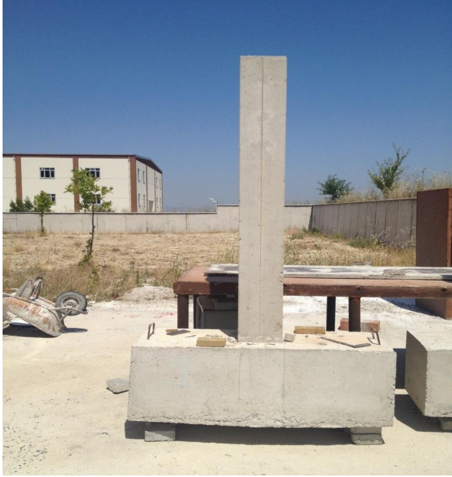
Şekil 3.18: Betonarme kolon numunesi
