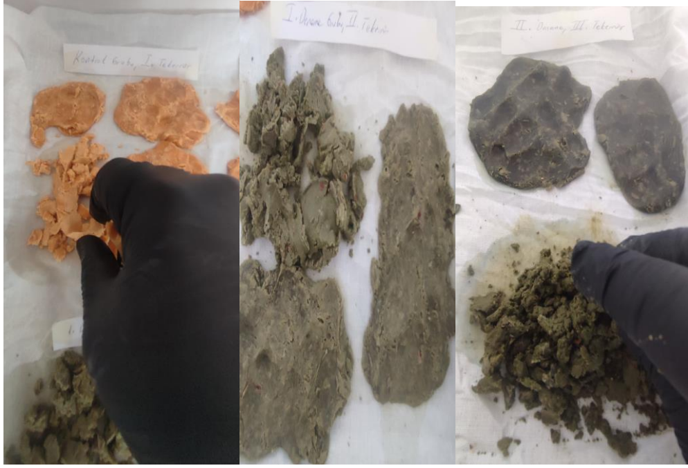
Şekil 135: Kontrol Grubu, Birinci Deneme Grubu ve İkinci Deneme Grubu Kurutma Sırasında Karıştırma İşlemi
