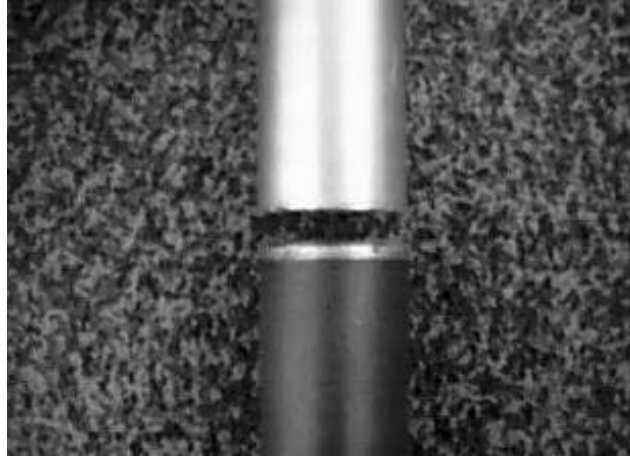
Şekil 5.40 Çekme numunesinin gevrek kırılma resmi
