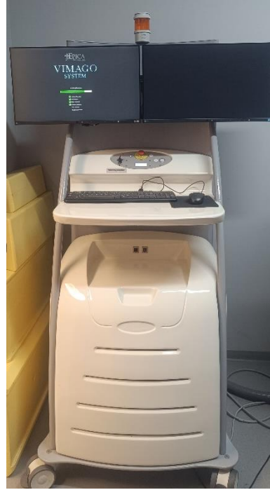
Şekil 3.3. Tomografi muayenesinde kullanılan bilgisayarlı görüntüleme sistemi.
