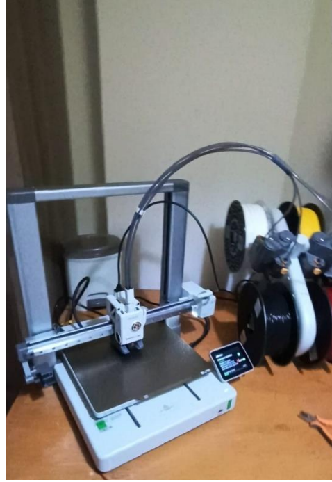
Şekil 3.5. Omurgaların basılması için kullanılan filament bazlı 3D printer yazıcı.
