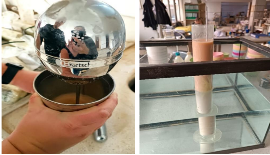
Şekil 4.11: Hidrometre deneyi görselleri
