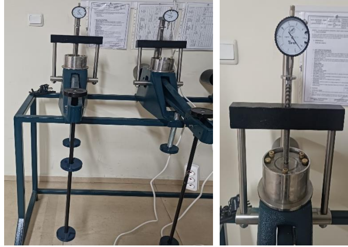
Şekil 4.52: Konsolidasyonda kullanılan ekipmanlar: yükleme ünitesi ve hassas ölçüm sistemi
