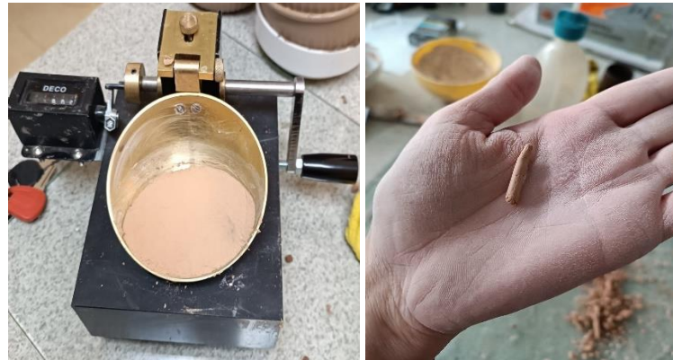
Şekil 4.1: Kilin likit limit ve plastik limit deneysel uygulama görselleri
