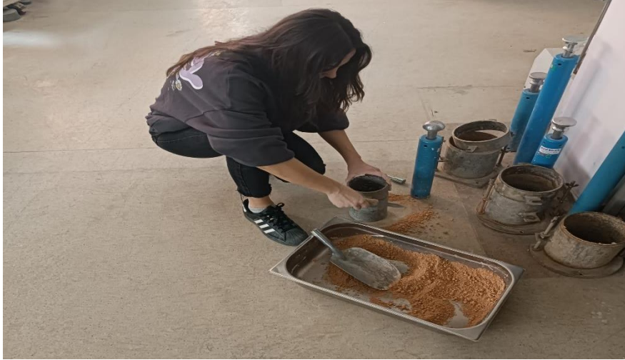
Şekil 4.33: Proktor deneyinin yapılması
