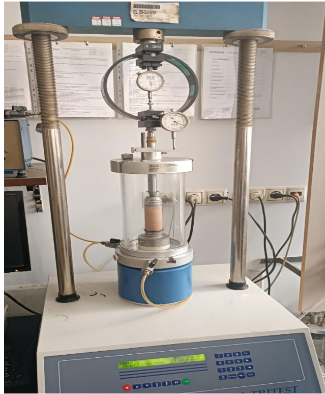
Şekil 4.34: Tek eksenli basınç dayanımı deneyi numuneleri
