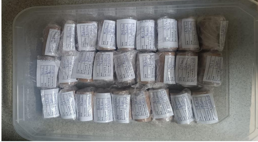
Şekil 4.34: Tek eksenli basınç dayanımı deneyi numuneleri
