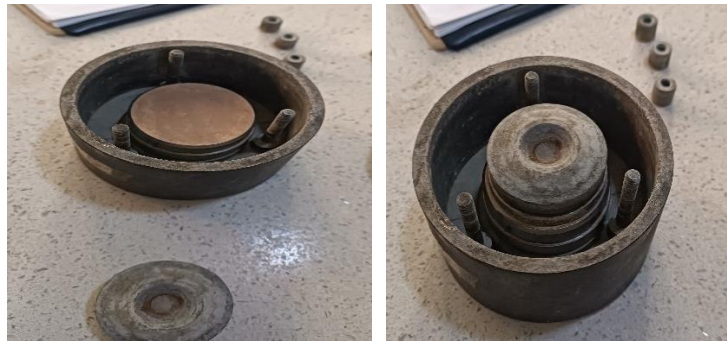
Şekil 4.51: Konsolidasyon deneyine ait numune yerleştirme ve düzenek hazırlama aşamaları
