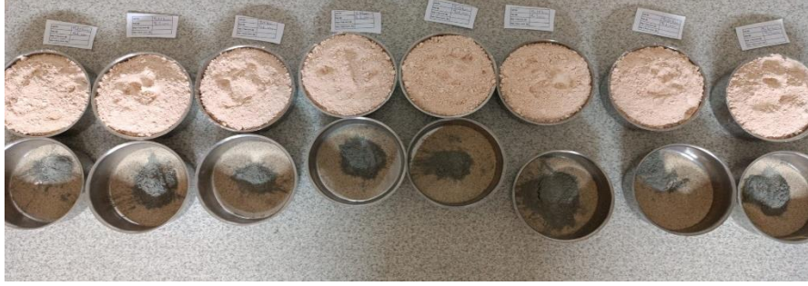
Şekil 4.32: Proktor için tek eksenli basınç numunelerinin hazırlanması
