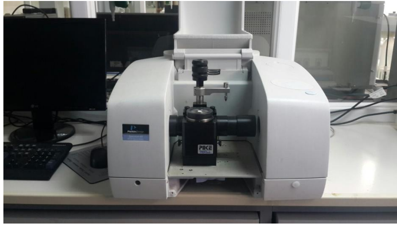
Şekil 2.1: İnfrared (IR) ölçümleri,Perkin-Elmer model spektrum 65 cihazı.
