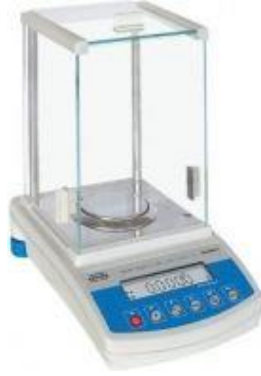
Şekil 2.3: Radwag wagi elektroniczne, AS 220/C/2 min.: 10 mg Max.: 220 mg d: 0.1 mg e: 1 mg T: - 220 g.
