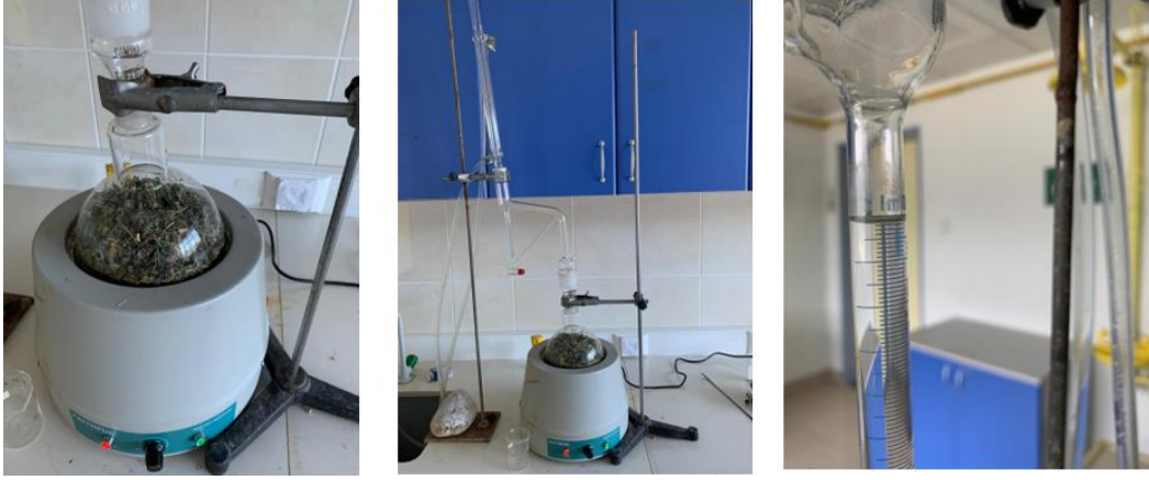
Şekil 2.1: Clevenger cihazı ile Lamium purpureum L. yağ eldesi
