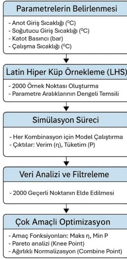
Şekil 3.26: Elektrolizör çalışma parametrelerinin belirlenmesine yönelik çok amaçlı optimizasyon sürecini gösteren yöntemsel akış diyagramı.
