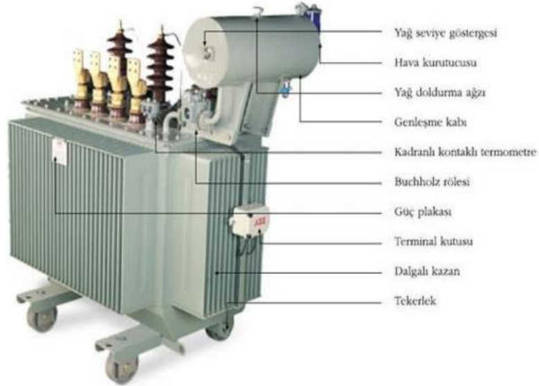
Şekil 1.1: Yağlı tip Trafonun yapısı [2]
