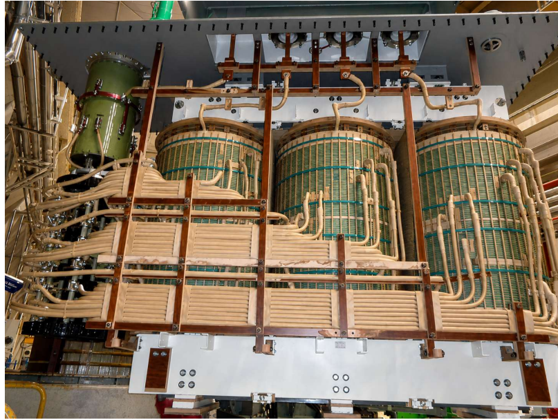
Şekil 3.1: Referans alınan 50 MVA güç transformatörünün genel görünümü
