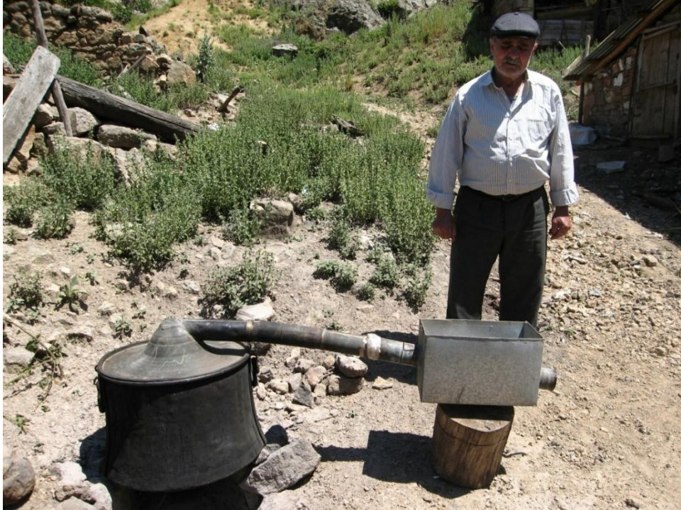
Şekil 5.7 Kekik suyu çıkarmada kullanılan İmbik
