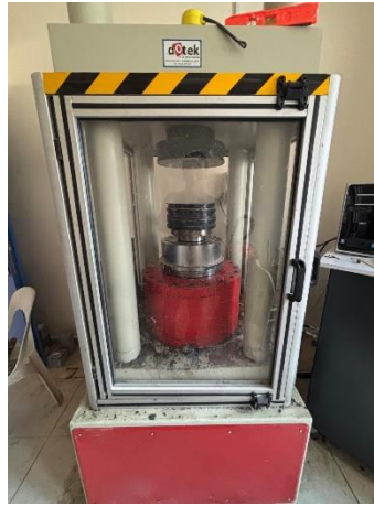
Şekil 6.9: Beton test presi
