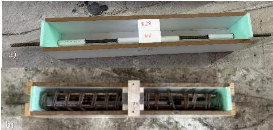
Şekil 6.4: Kiriş kalıpları; a) Lifli UYPB kalıpları b) Lifsiz UYPB kalıpları
