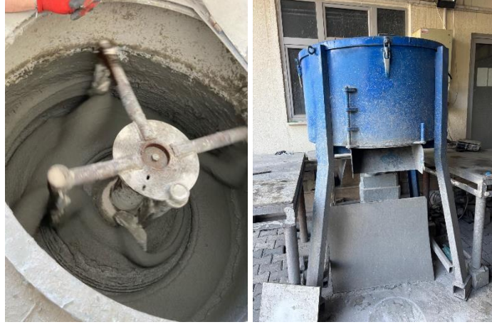
Şekil 6.6: UYPLB üretiminde kullanılan pan mikser
