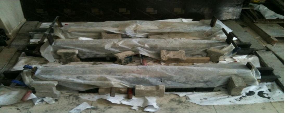
Şekil 2.9: Plastik örtü ile kürlenmiş deney kirişleri
