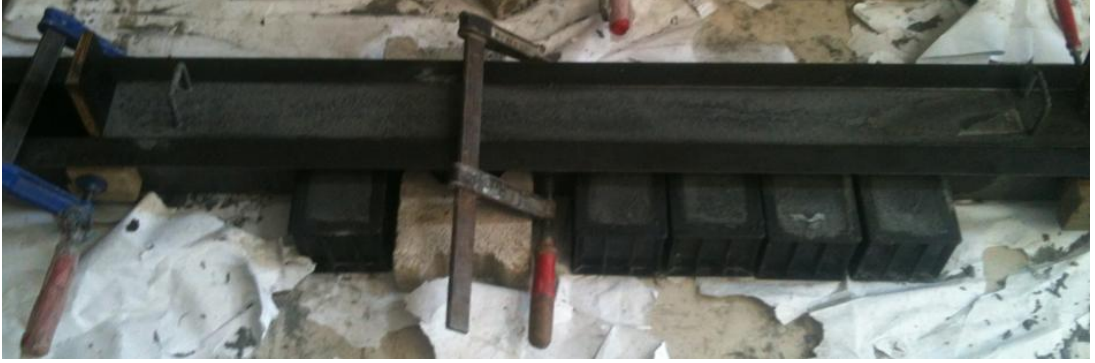
Şekil 2.8: Döküm sonrası deney kirişi
