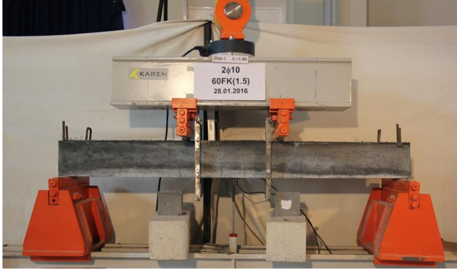
Şekil 2.13: Kiriş eğilme deney düzenegi
