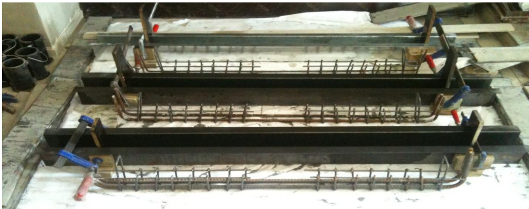
Şekil 2.5: Kalıpların ve donatıların hazırlanması
