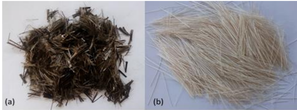
Şekil 2.3: Kirişlerin üretiminde kullanılan lif tipleri (a) bazalt lif (b) poliamid lif
