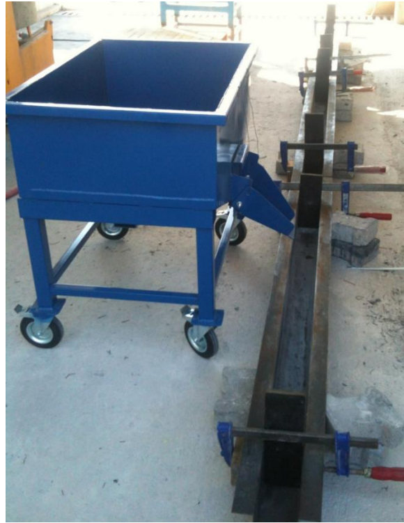
řekil 2.7: UYPLB'un hazırlanması ve kiriř kalıplarına yerleřtirilmesi
