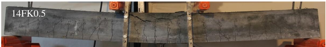
Şekil 3.29: 2φ10 donatılı poliamid lifli kirişlerin kırılma şekilleri
