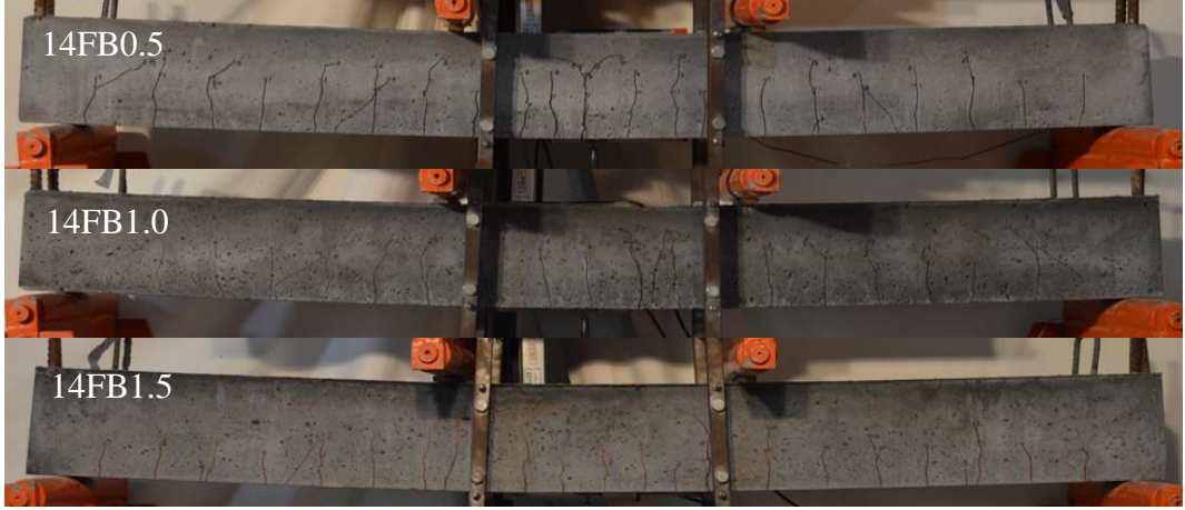
Şekil 3.22: 2 \phi 14 donatılı bazalt lifli kirişlerin L/70 yerdeğiřtirmesi için çatlak dağılımları
