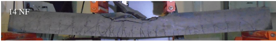
Şekil 3.4: 2φ14 donatılı lifsiz kirişin kırılma şekli
