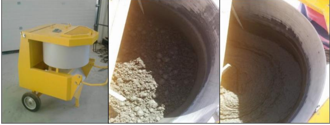
řekil 2.6: UYPLB'un panmikserde hazırlanması ařamaları
