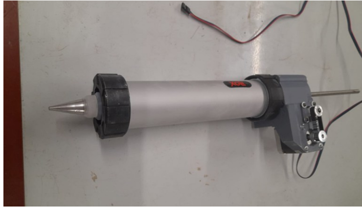
Şekil 7. Gerçekleştirilen doğrudan kil ekstrüzyon sistemi
