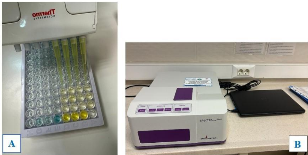
Şekil 3.2. ELISA aşamaları. A: durdurma solüsyonu eklenmesinin sonucu kuyudaki rengin maviden sarıya dönmesi, B: ELISA plaka okuyucu.
