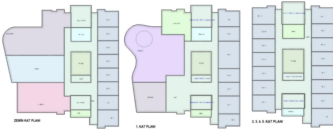
Şekil 3.8: Benzetim programında çizilen kat planları ve ısıl bölgelemeler.
