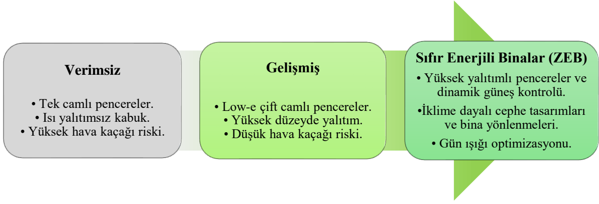
Şekil 1.2: Cephe sistemlerinin enerji verimliliği açısından gelişim süreci (LaFrance, 2013).
