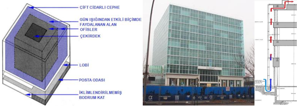
Şekil 2.16: Occidental Kimya Merkezi, ısıl bölgeleme, ofis binası görünüşü ve çift kabuk cephe sistemi havalandırma şeması (Boake and Harrison, t.y.).
