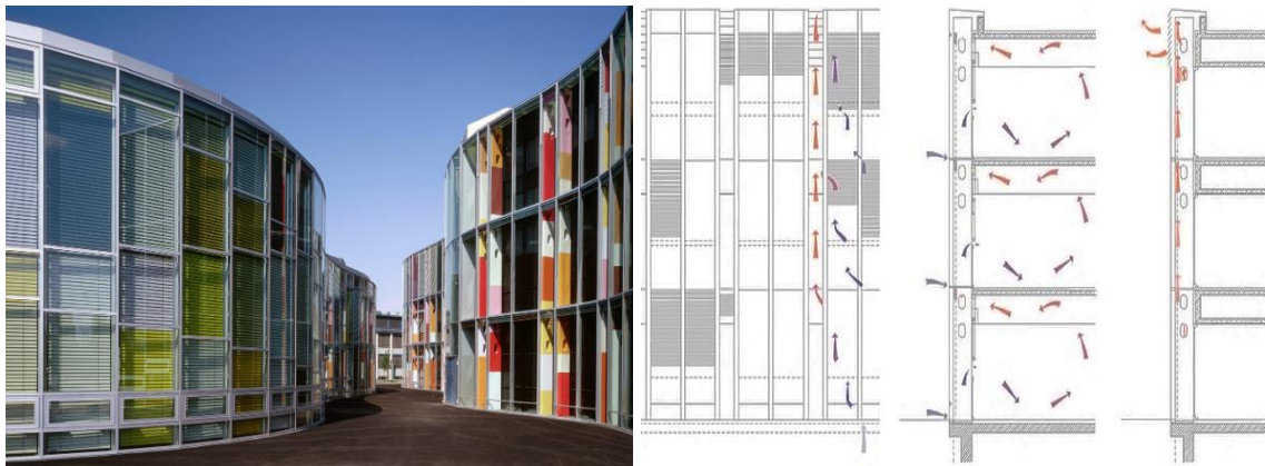
Şekil 2.19: Fotonik Merkezi'nin cephesi ve hava akışını gösteren görünüş ve kesitler (URL-8).
