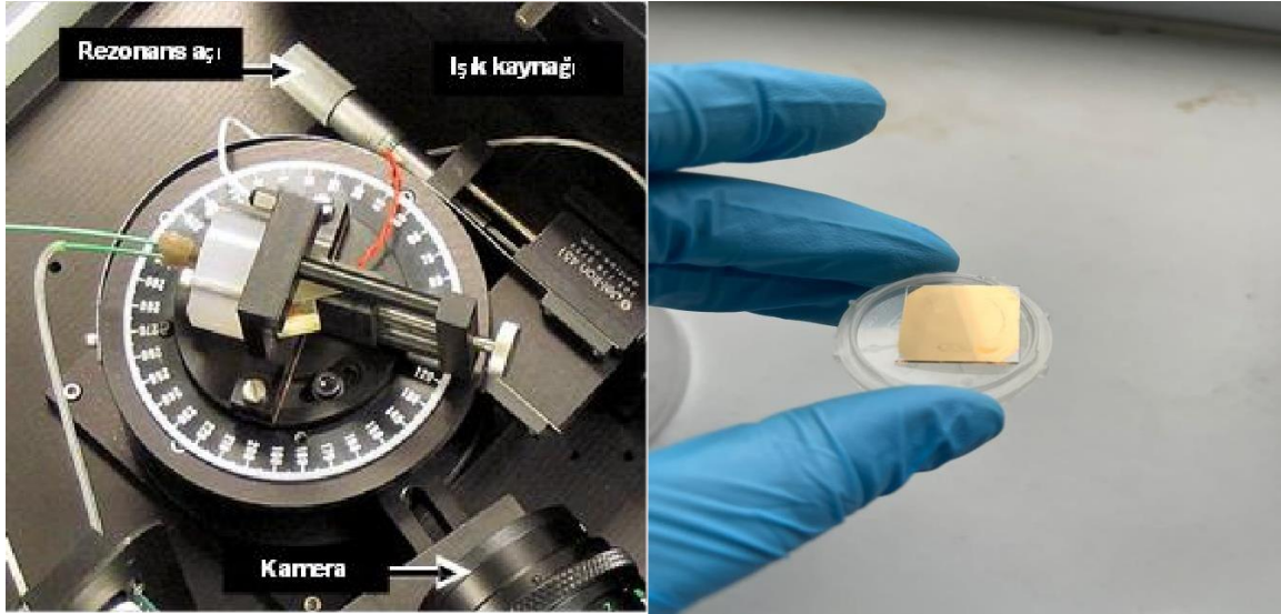
Şekil 2.1: (a) Yüzey plazmon rezonans (SPR) sensör sistemi; ve (b) SPR çip
