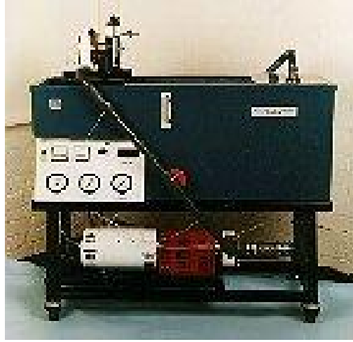
ekil 2. Santrifüj pompa-türbin e itim seti (GH5) [6]
