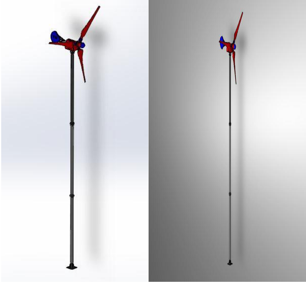
Şekil 7.30: 3 kW'lık rüzgar türbini montajı.
