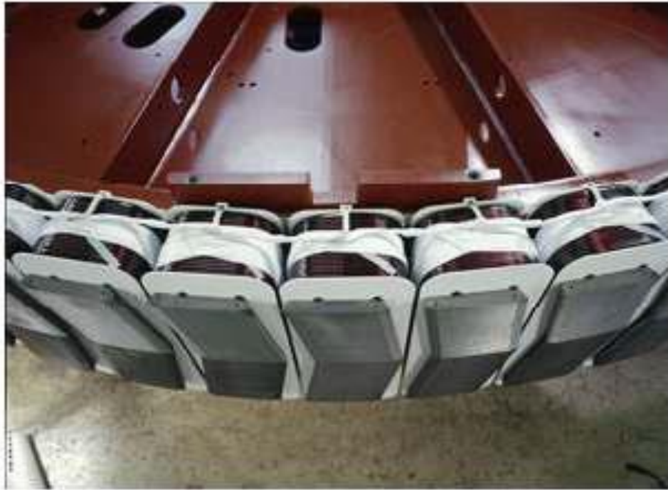
Şekil 4.4: Direct Drive sistemli Enercon jeneratör [1].
