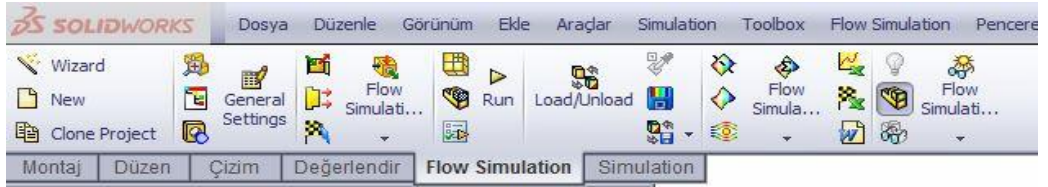
Şekil 8.11: Analiz sihibazı çalıştırılması.
