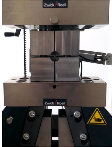
Şekil A.2: ASTM D6641 Basma Test Düzeneği
