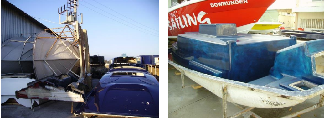
Şekil 1.10: Polyester tekne gövde ve güverte kalıpları (Mercan Yat Ltd. Şti, Çiğli, İzmir).
