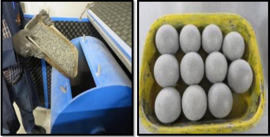
Şekil 4.11: Los angeles makinesi ve bilyeler [22]
