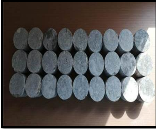
Şekil 5.3: Kesilmiş ve başlıklanmış karot numuneleri
