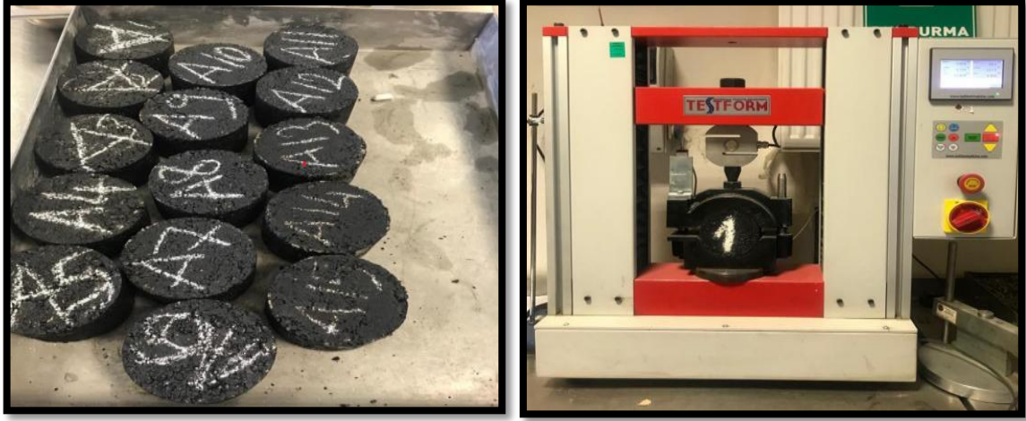
Şekil 4.14: Marshall deneyinin aşamaları [25]
