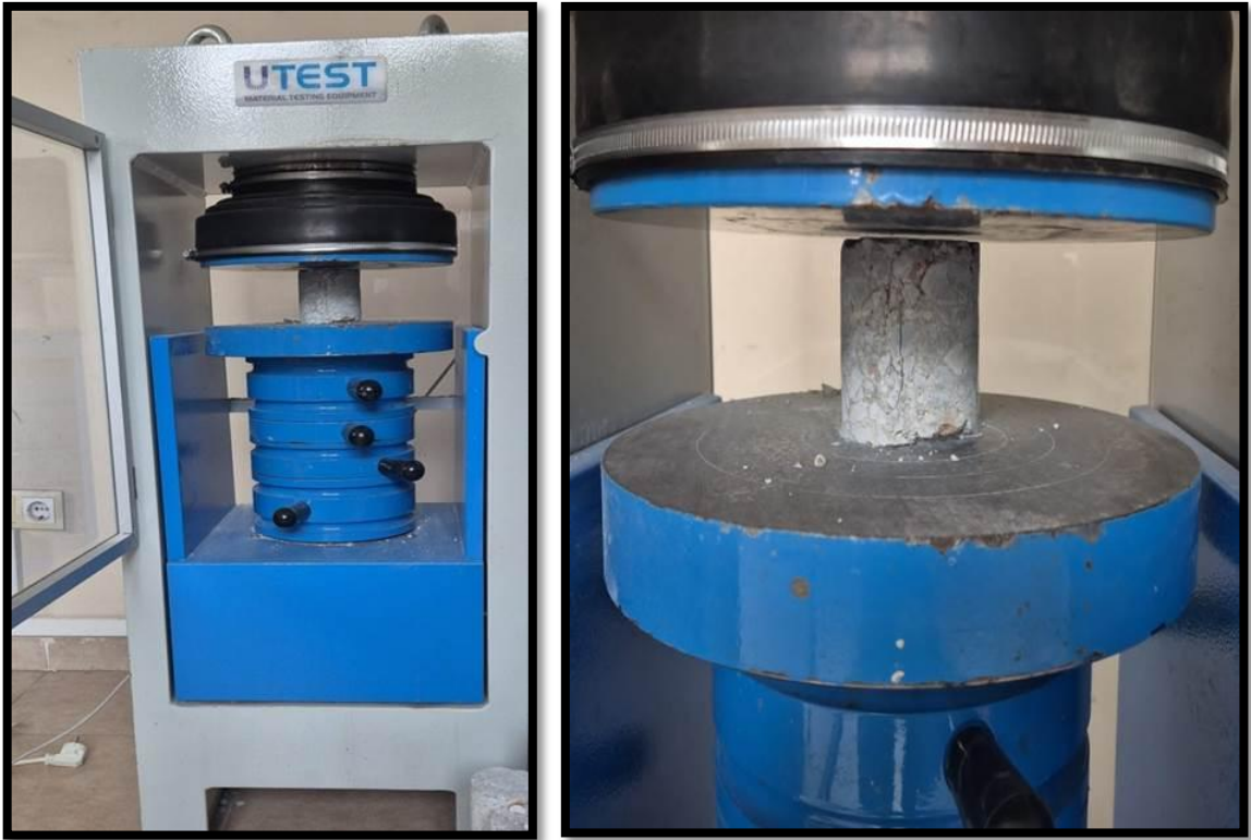
Şekil 4.30: Karotta basınç dayanımı deneyi
