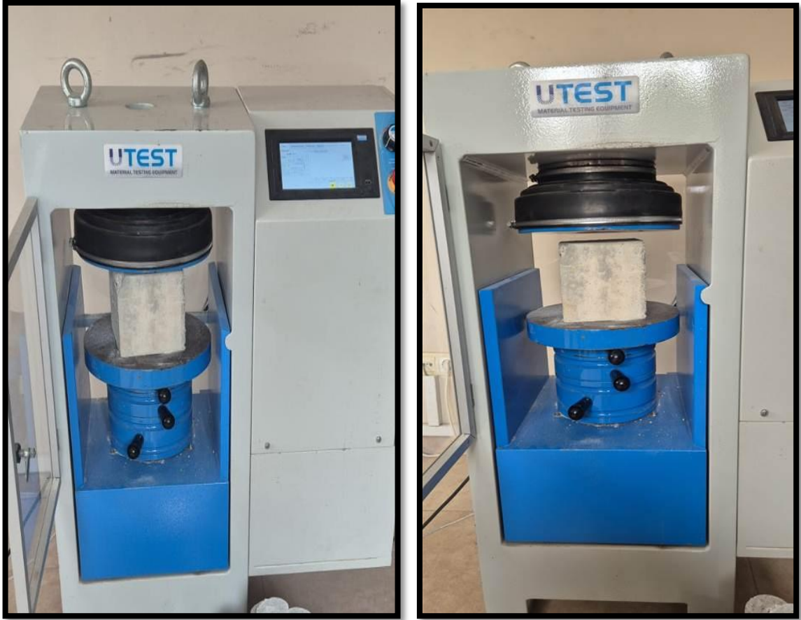
Şekil 4.31: Taze betonda basınç dayanımı deneyi
