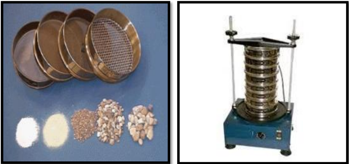
Şekil 4.12: Elek analizi seti ve elek sarsıcısı [26]
