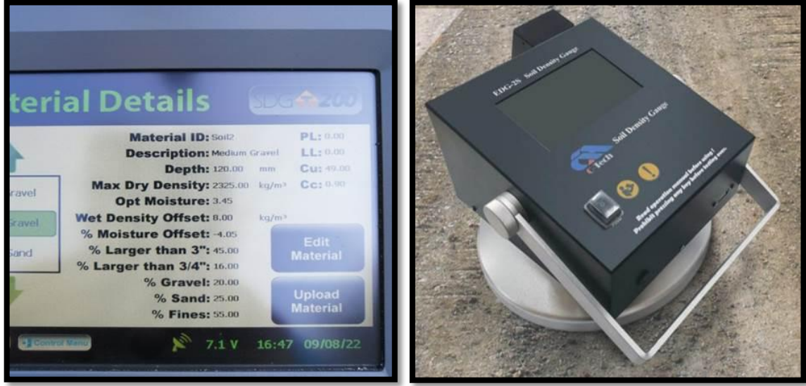
Şekil 4.16: Nükleer olmayan zemin yoğunluk cihazı ile sıkışma kontrolü
