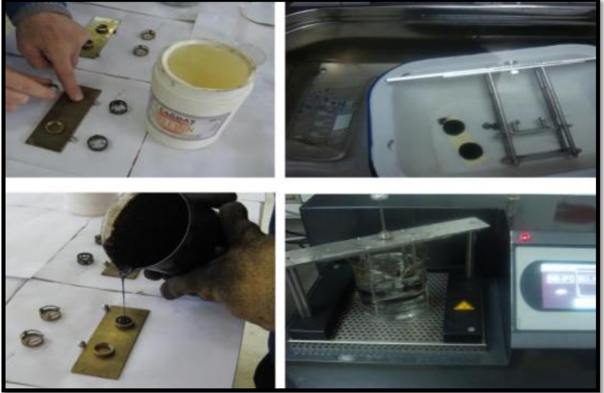
Şekil 4.13: Yumuşama noktası deneyinin aşamaları [27]
