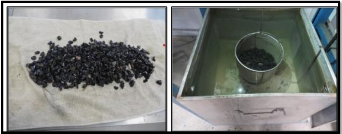
Şekil 4.9: Doygun yüzey hale getirilen agrega ve tel sepette kütle belirlenmesi [22]
