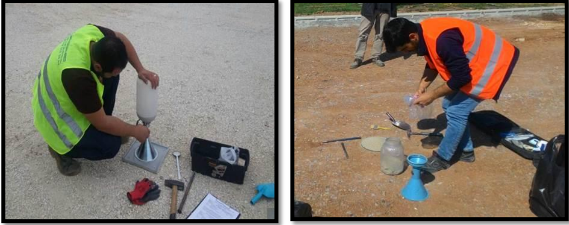
Şekil 4.17: Kum konisi deneyi ile sıkışma kontrolü [28]
