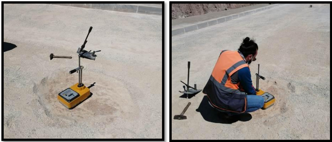
Şekil 4.15: Nükleer proktor test ile sıkışma kontrolü
