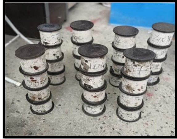
Şekil 5.3: Kesilmiş ve başlıklanmış karot numuneleri
