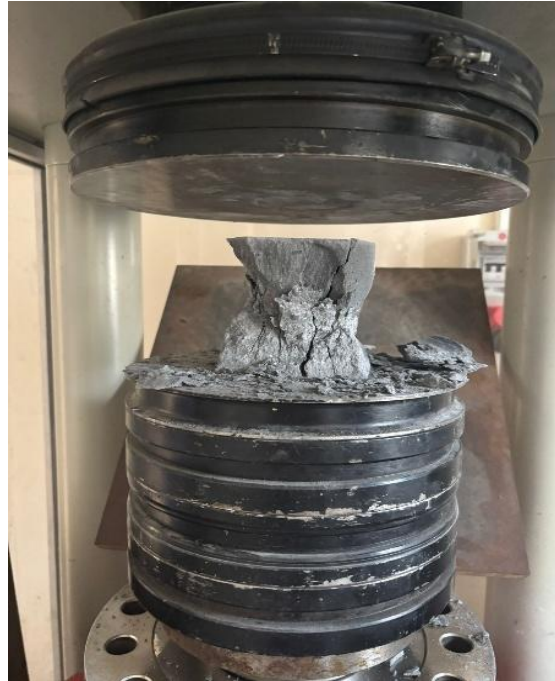
Şekil 3.18: Basınç dayanımı ölçülmüş UYPGB
