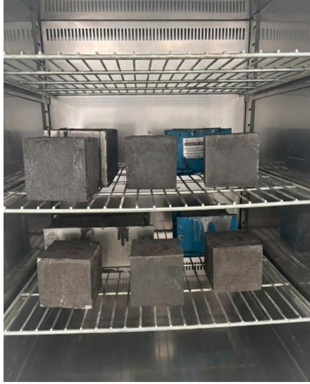
Şekil 3.14: Hazırlanan UYPGB'ların etüv görüntüsü
