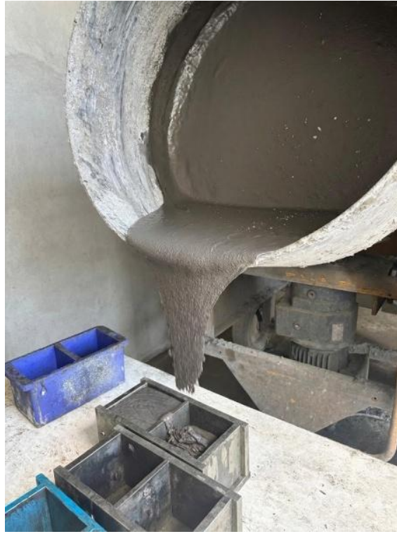
Şekil 3.13: Hazırlanan UYPGB'nin kalıplara dökümü
