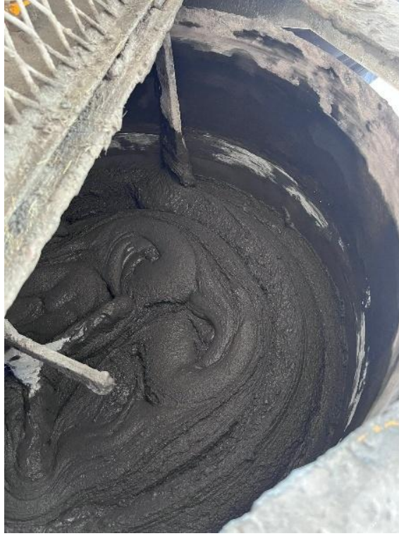
Şekil 3.11: Kalan silis dumanının karışıma ilave edildikten sonraki hali
