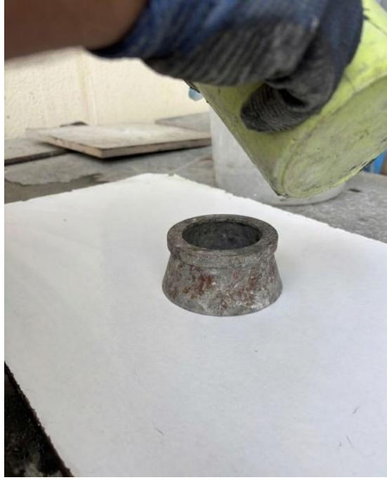
Şekil 3.15: Hazırlanan UYPGB'nin yayılma hunisine dökümü
