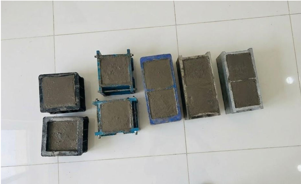
Şekil 3.12: Hazırlanan UYPGB'nin kürleme öncesi kalıplara dökülmüş hali
