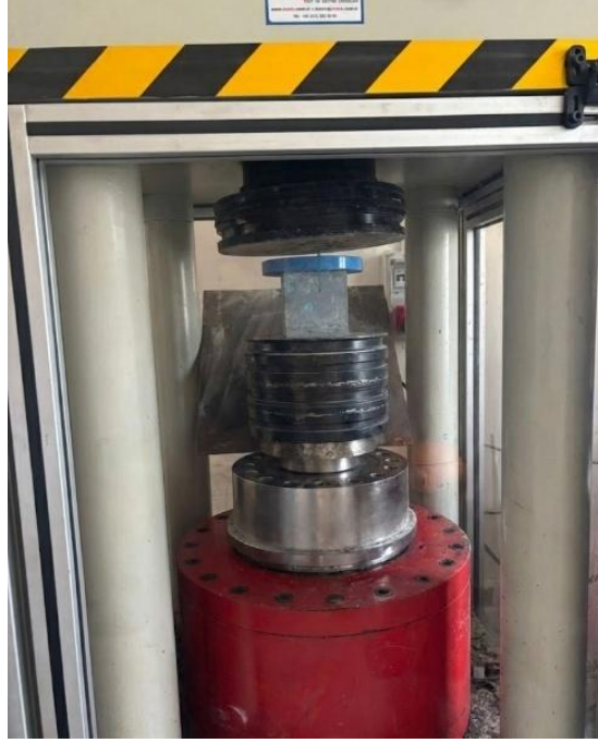
Şekil 3.17: Basınç dayanımı ölçülen UYPGB
