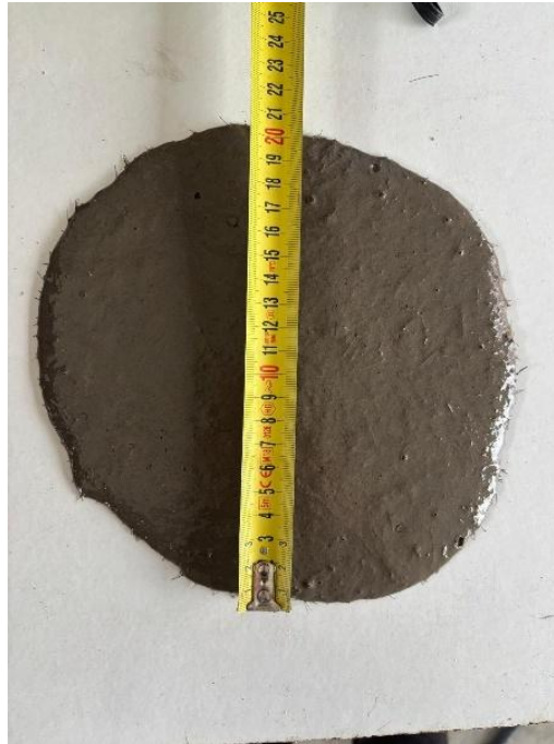
Şekil 3.16: Hazırlanan UYPGB'nin yayılma ölçümü
