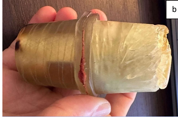
Şekil 3.52: \pm 45^\circ için von misses gerilme karşılaştırması a) Analiz, b) Test
