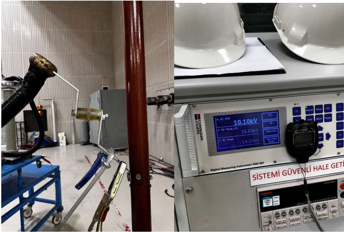
Şekil 3.33: 10 kV altındau uygulanan gerilim testi
