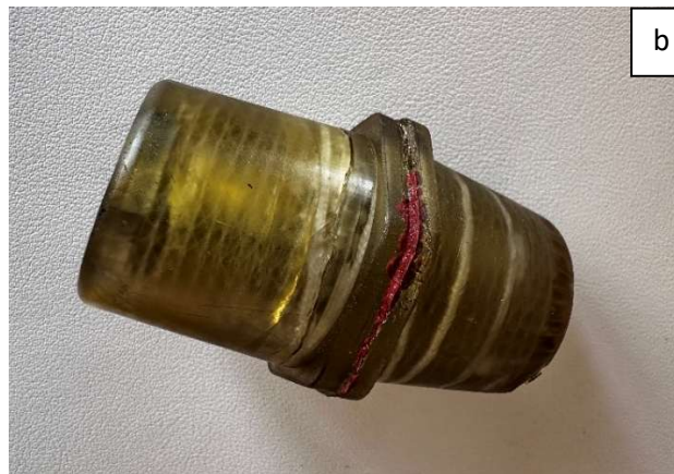
Şekil 3.42: 90° için von misses gerilme karşılaştırması a) Analiz, b) Test
