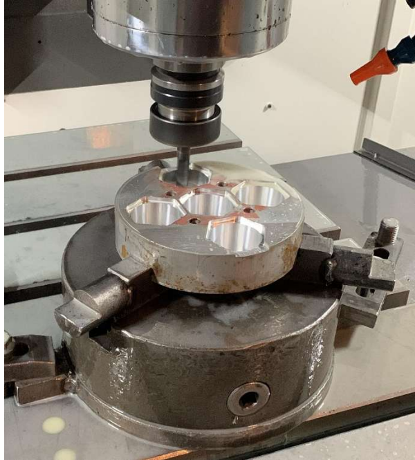
Şekil 2.6: Kalıbın frezede işlenmesi
