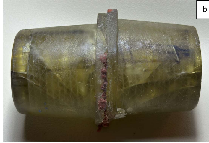
Şekil 3.68: \pm 90^\circ için von misses gerilme karşılaştırması a) Analiz, b) Test
