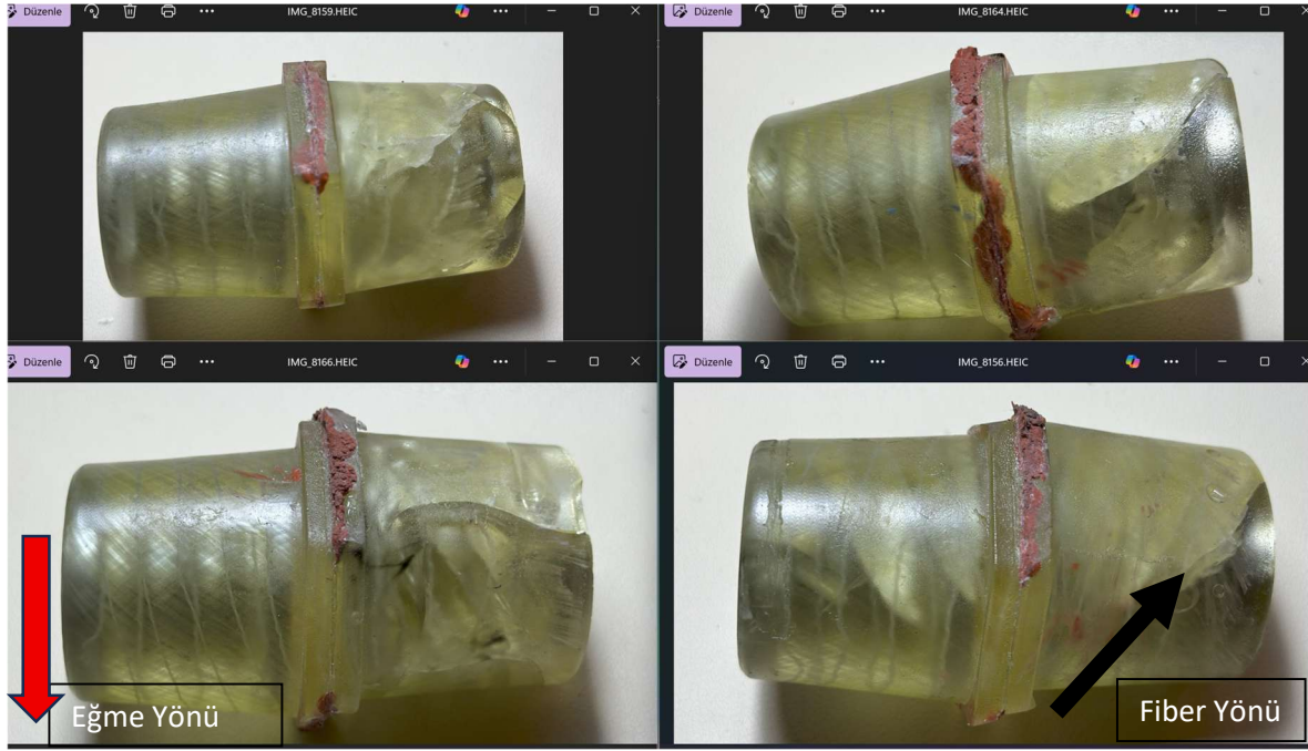
Şekil 3.25: \pm 45^\circ laminasyonlu numunelerin test sonucu görselleri
