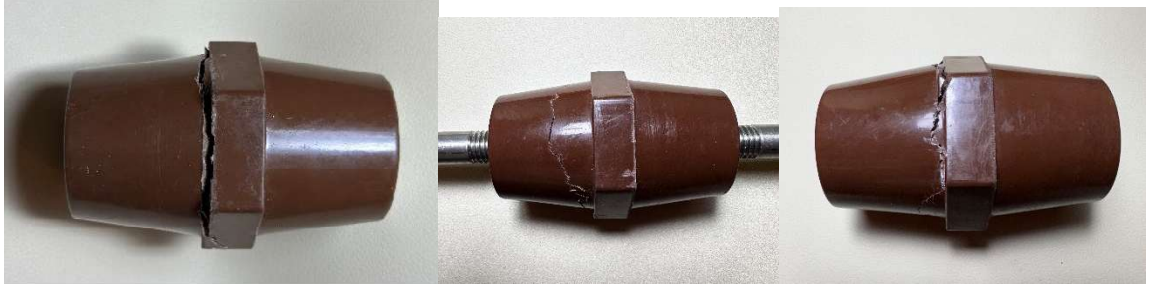
Şekil 3.29: Kum katkılı tesiste üretilen numunelerin test sonucu görselleri
