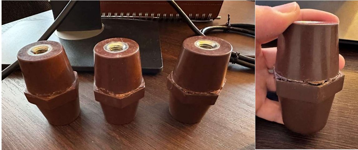
Şekil 3.13: Mevcut kullanılan izolatör numunelerinin test sonucu görselleri Grafik ve numune fotoğrafları birlikte değerlendirildiğinde, ticari olarak temin edilen ve mevcut kullanılan izolatörün çekme davranışının baştan sona artan bir kuvvet–uzama eğrisiyle karakterize olduğu, yaklaşık 3,3–3,5 mm uzamada 17–18 kN mertebesinde tepe değere ulaştığı ve hemen ardından ani bir taşıma kaybı yaşandığı görülmektedir.
