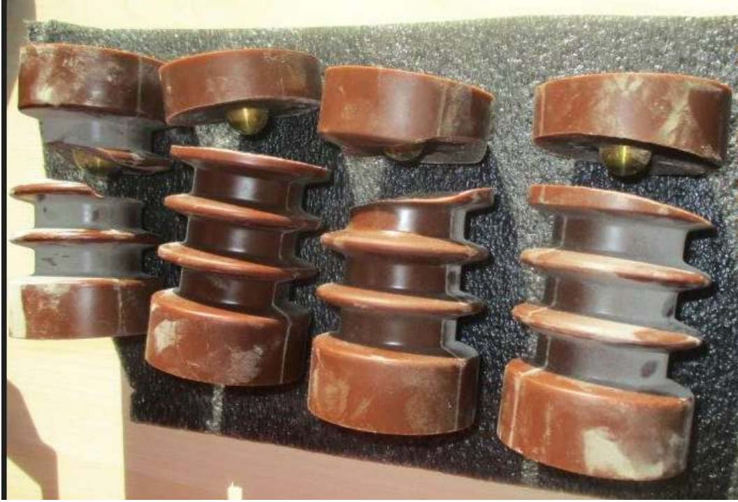
Şekil 1.3: Sevk sonrası kırılmış izolatörler
