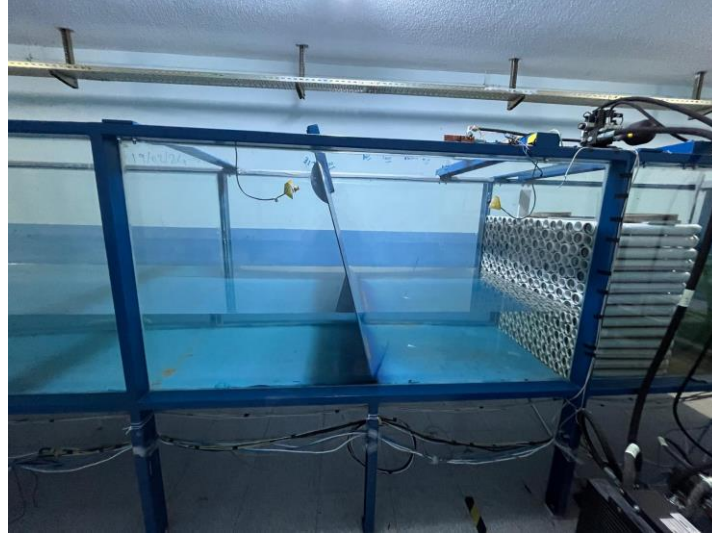
Şekil 3.3: Flap tip dalga üretici.
