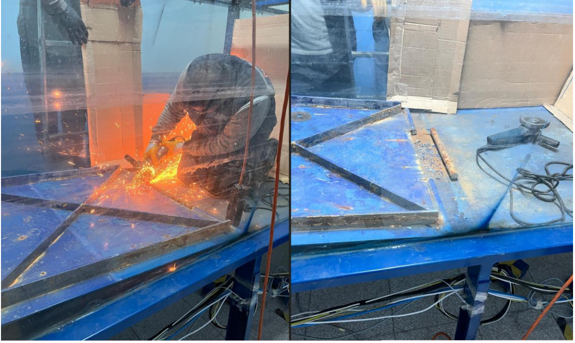
Şekil 6.3: Flap tip dalga üretici sökme işlemi.
