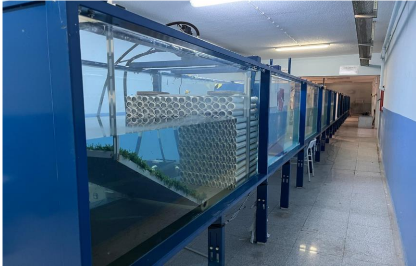
Şekil 3.2: Flap tip dalga üreticili dalga kanalı.
