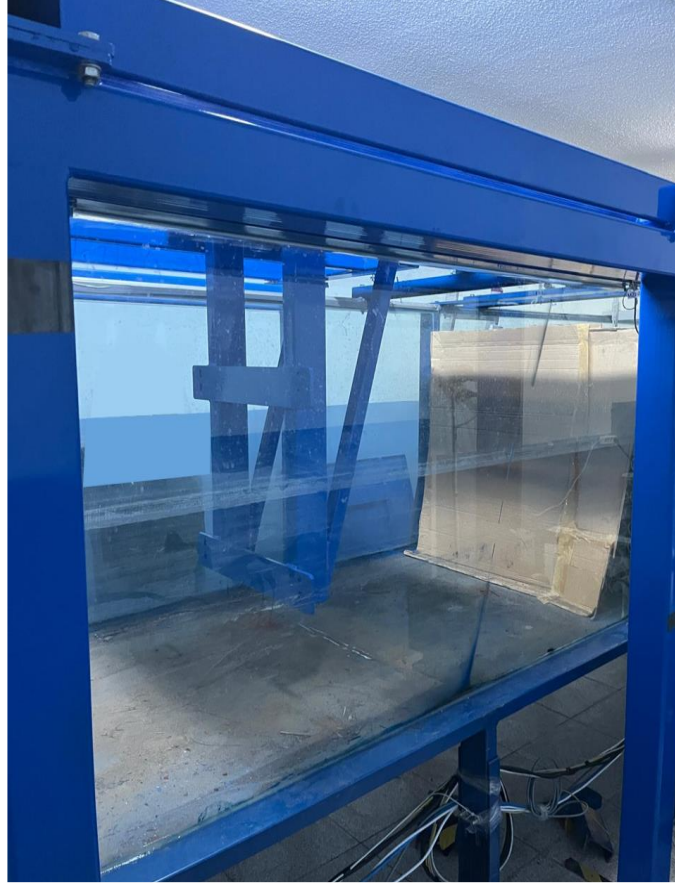
Şekil 6.4: Piston tip dalga üretici montaj aşaması.
