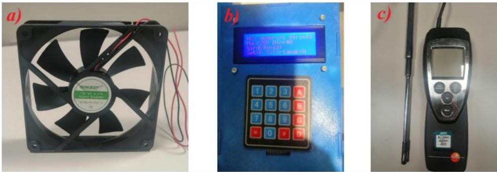
Şekil 2.3: a) Fan, b) Kontrol ünitesi, c) Anemometre.
