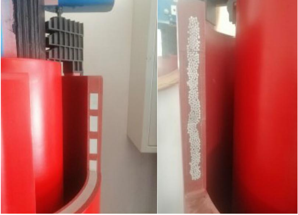
Şekil 1.7: YG iletkenleri (a)Strip iletken ile sarılan bir YG sargısı (b)Yuvarlak iletken ile sarılan bir YG sargısı.
