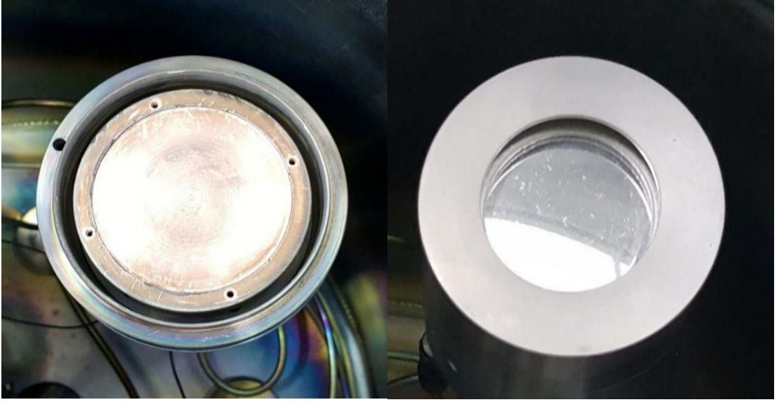
Şekil 3.18: Magnetronun yüzeyi (a) ve Montaj sonrasında koruyucu (b) ile birlikte görünümü.
