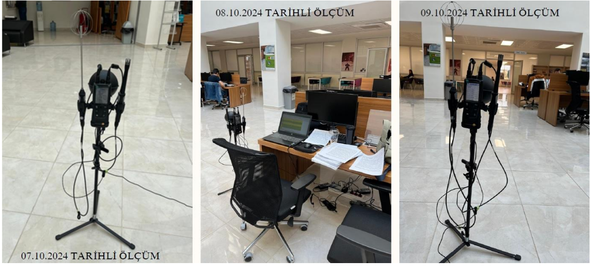
Şekil 4.18: ASHRAE 55-2010 standardına göre ölçüm aletlerinin kullanım şekli.
