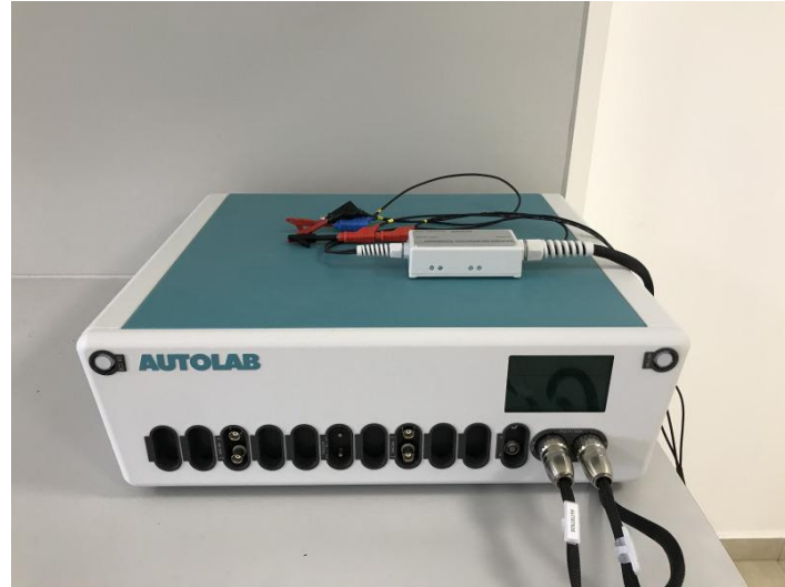
Şekil 1.9: Elektrokimya araştırmalarında kullanılan modern hücre düzeneği ( https://hunitek.hacettepe.edu.tr/elektrokimyasalanaliz )
