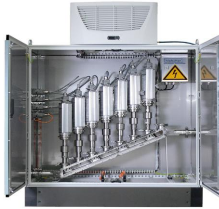
Şekil 1.10: Ultrasonik homojenizatör model (7x1 Kw Ultrasonikgüç)
