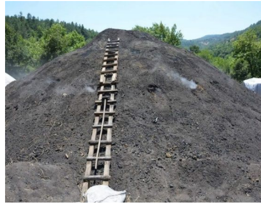
Foto 3-4: Odunların ortasında baca oluşturacak şekilde dizildiği ve yanmanın dengeli olabilmesi için havalandırma delikleri açılan odun kömürü ocağı
