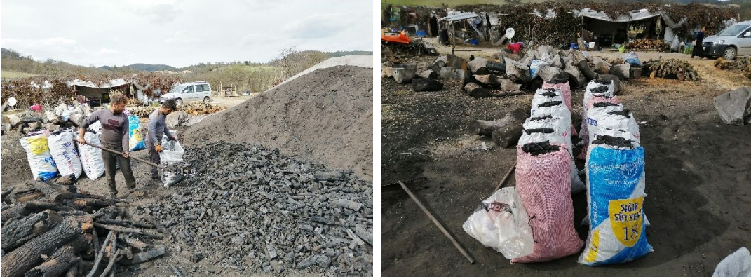
Foto 5-6: Yanması tamamlanan ve üzerindeki toprağın kaldırılıp çuvalara doldurulan odun kömürü
