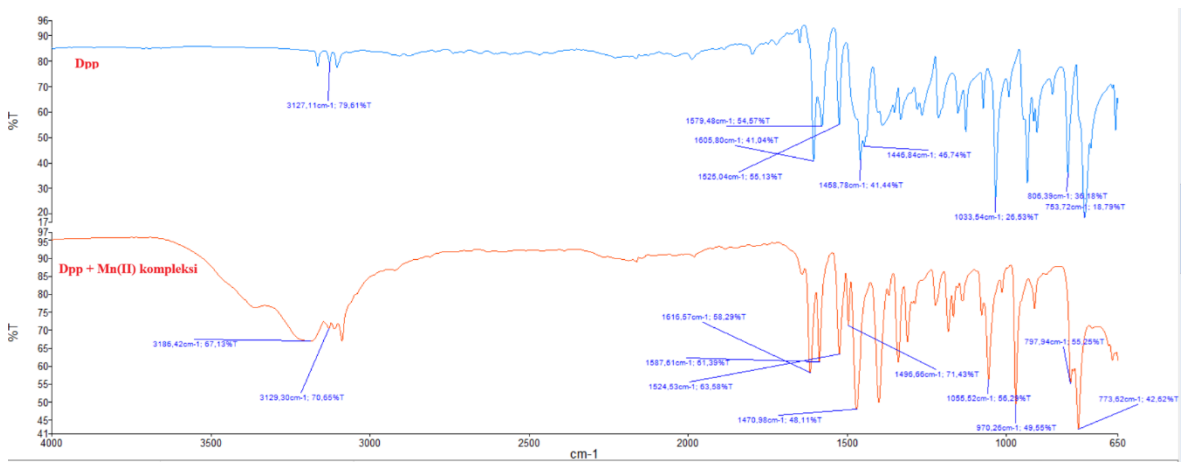
Şekil 3.11: Dpp ligantı ile dpp+Mn(II) kompleksinin katı IR ölçümleri
