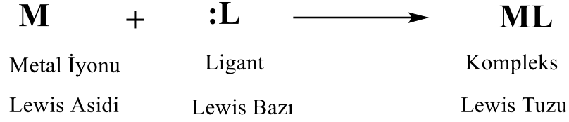
Şekil 1.15: Metal iyonu ile ligantın Lewis Asit Baz Tepkimesi
