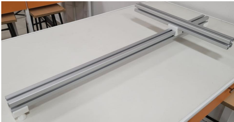
Şekil 4.5: 100 cm x 50 cm ebatlarında iki eksen taşıyıcı sistemin son hali
