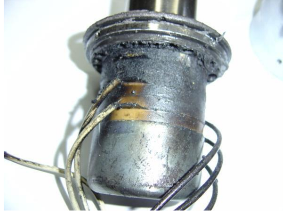
Şekil 8.15: Hasar görmüş enerji dönüştürücü (conventer) [12].
