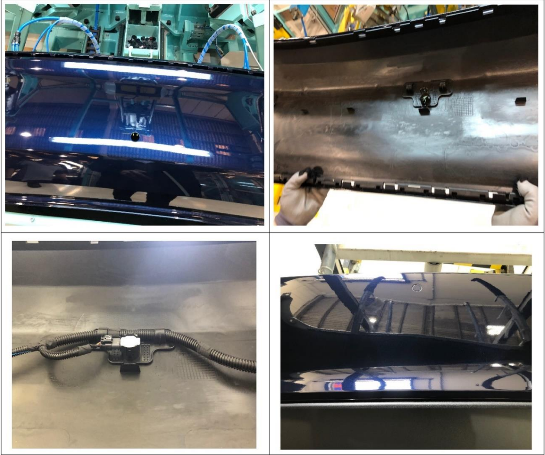
Şekil 11.2: Ultrasonik kaynak öncesi ve sonrası görüntüleri.
