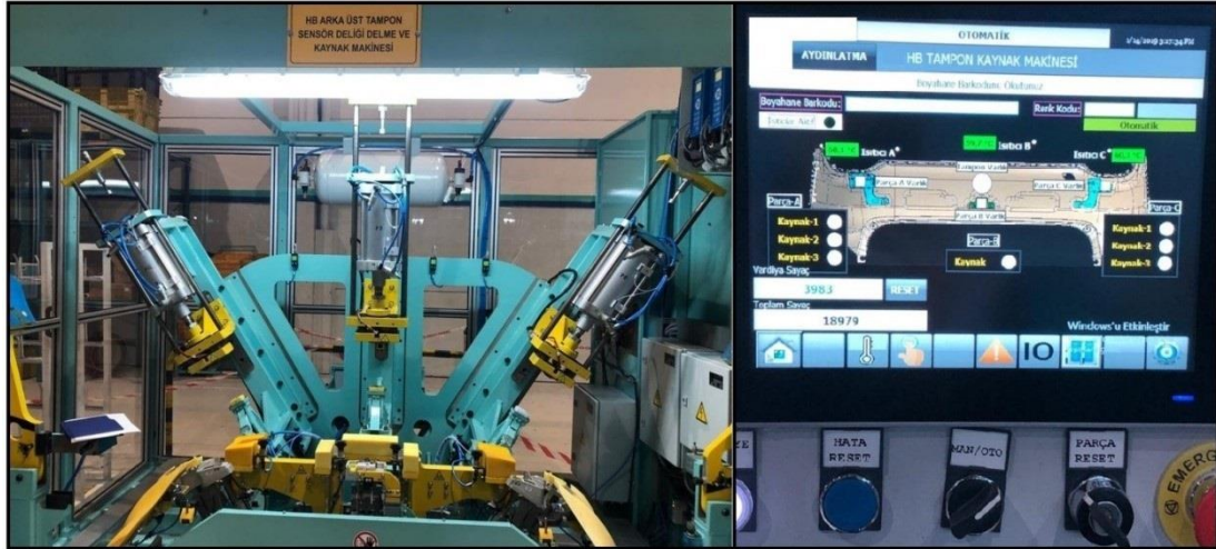
Şekil 11.1: Ultrasonik kaynak makinesi ve makinenin operatör paneli ekran görüntüsü.
