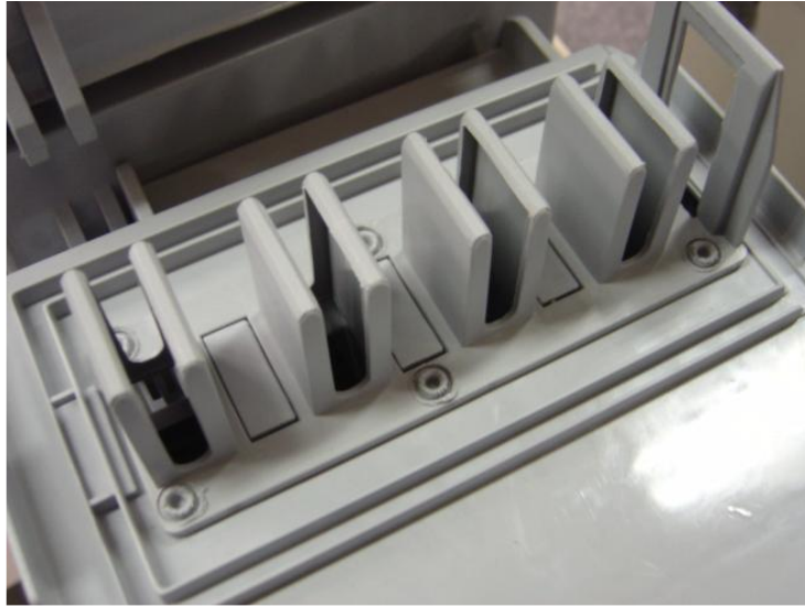
Şekil 8.9: Ultrasonik kaynak yöntemi perçin başı ezme uygulaması [14].
