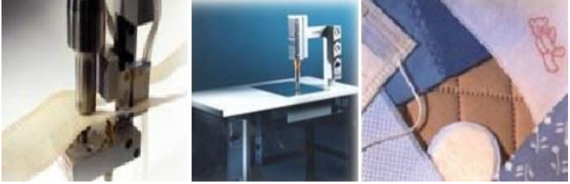
Şekil 8.12: Ultrasonik kaynak yöntemi kesme ve kumaş dikme uygulaması [14].
