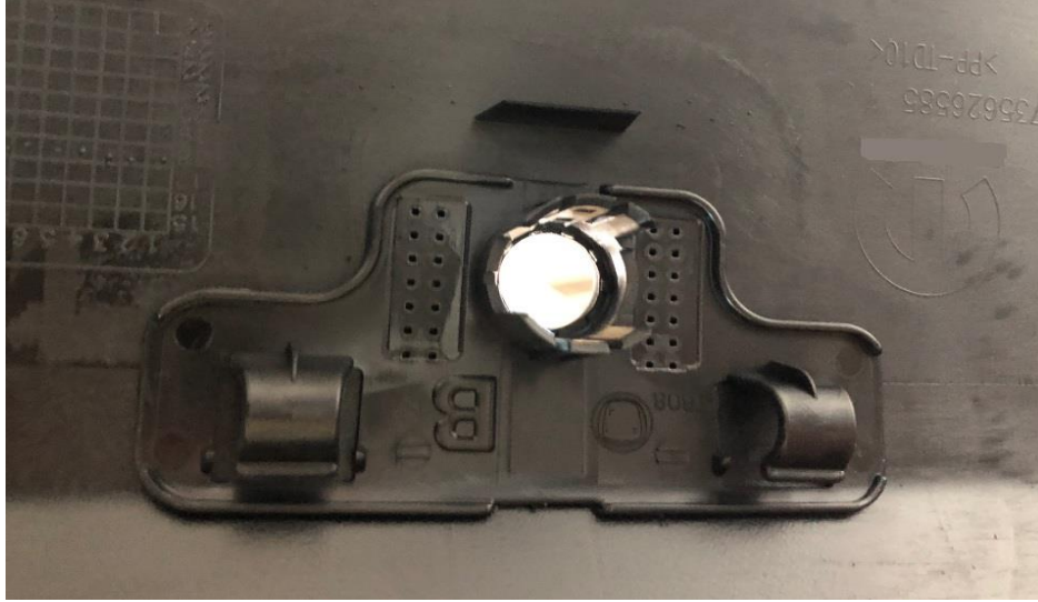
Şekil 11.8: Ultrasonik kaynak yapılmış sensör braket.
