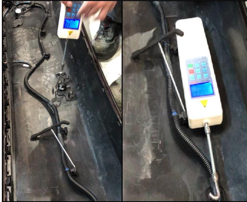
Şekil 11.6: Dinamometre ve çekme düzeneği.
