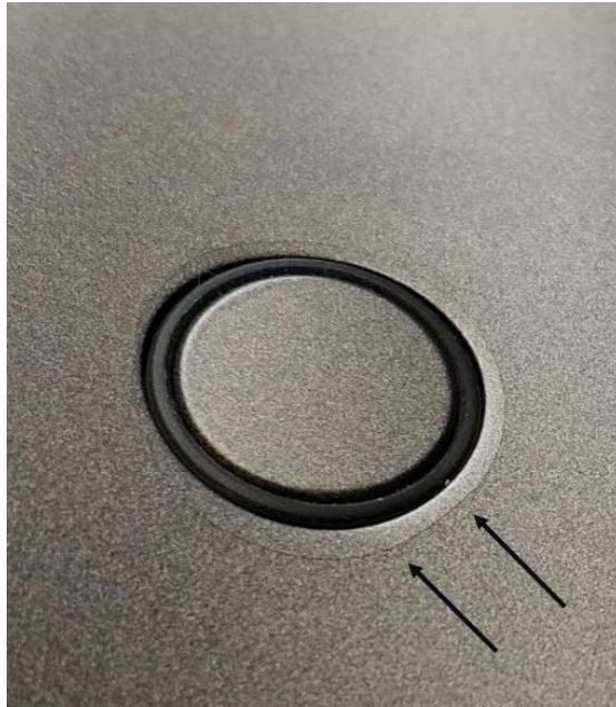
Şekil 11.10: Görsel yüzeyde çatlaklar.
