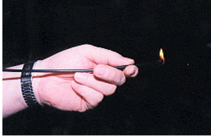
Şekil 10.1: Uygun kaynak yönteminin yanma metodu ile belirlenmesi [8].
