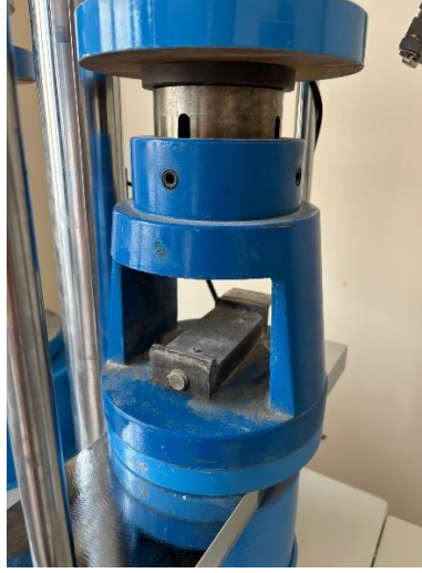
Şekil 3.11: Eğilmede çekme dayanımı için kullanılan başlık
