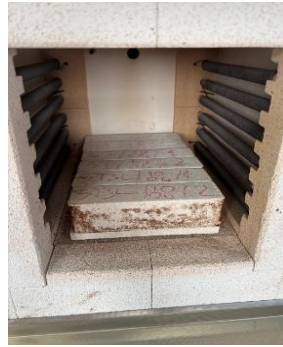
Şekil 3.13: Yüksek sıcaklık fırınında deney öncesi numuneler
