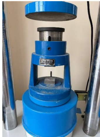
Şekil 3.9: Basınç dayanımı için kullanılan prizma başlık
