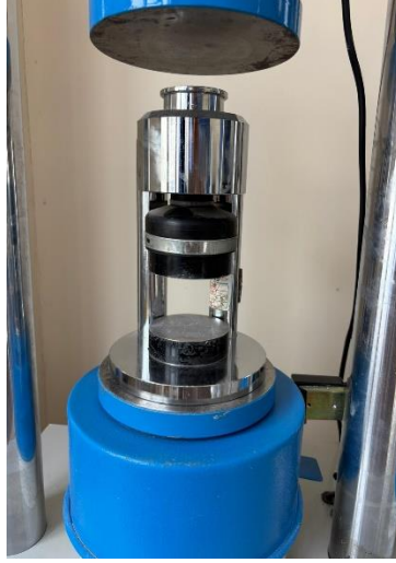
Şekil 3.10: Basınç dayanımı için kullanılan küp başlık
