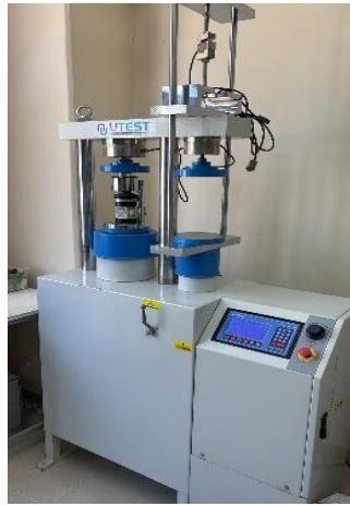
Şekil 3.8: Beton pres makinesi
