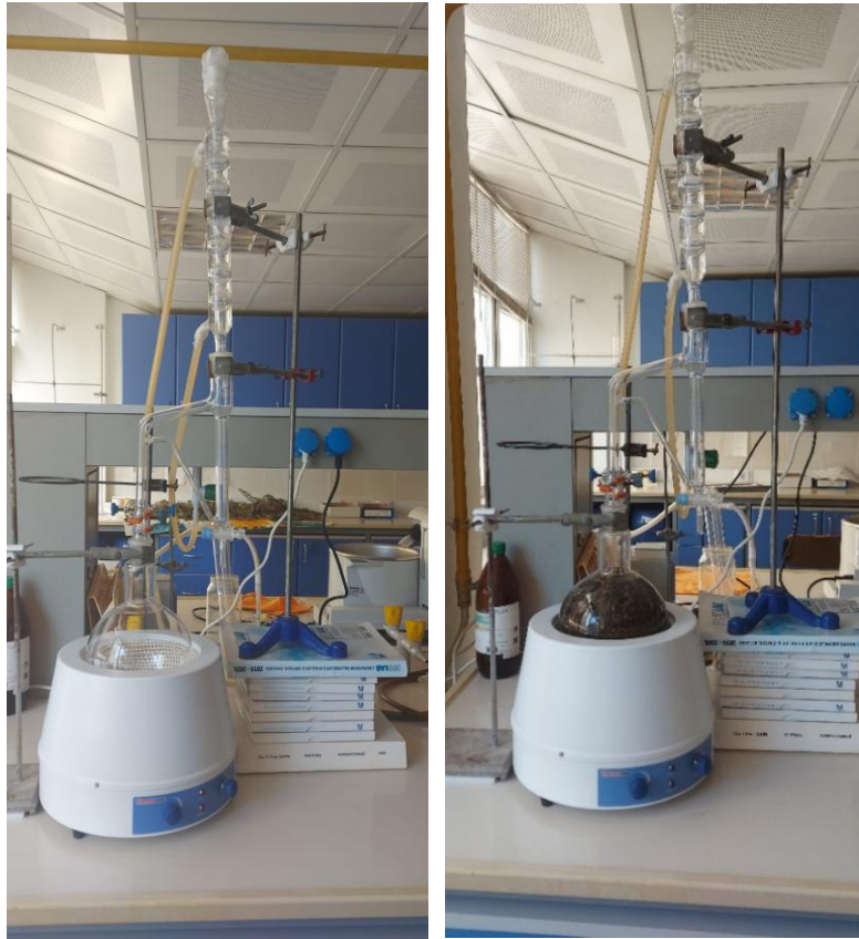
Şekil 2.1: Uçucu yağ elde etme düzeneği
