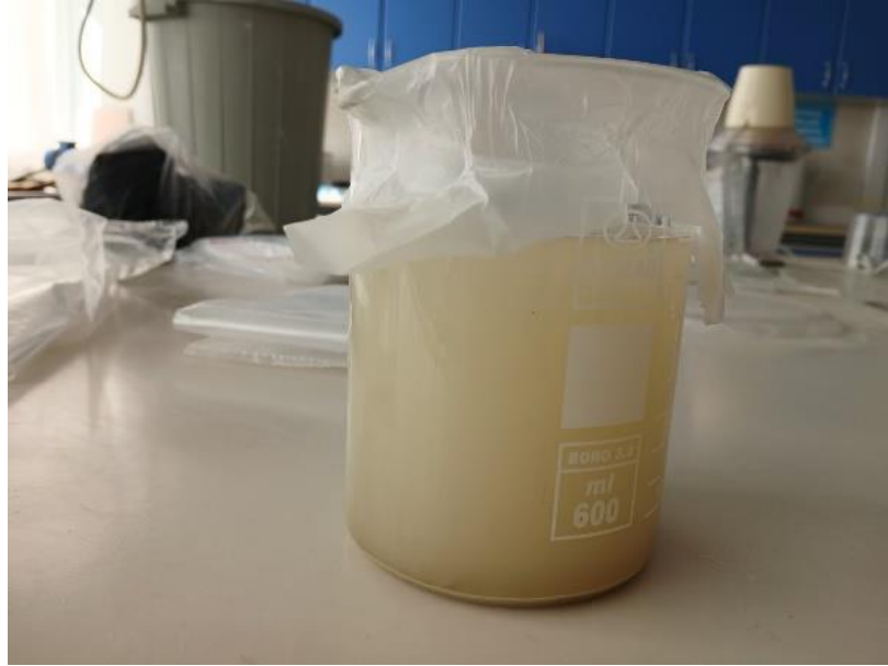
Şekil 3.1: Karıştırıcıdan alınan etanol ortamında çöktürülmüş nano ölçekli zeolitinin t=0 anında beherdeki görüntüsü
