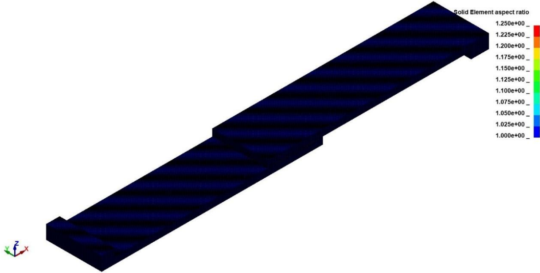
Şekil 3.13: 0,25 mm eleman boyutuna sahip modelin ağ yapısı ve katı eleman en boy oranı (aspect ratio)
