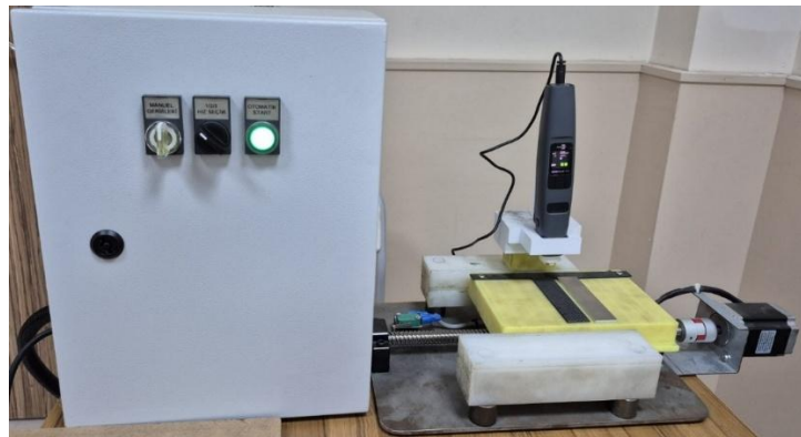
Şekil 2.11: Atmosferik basınçlı soğuk plazma uygulama sistemi
