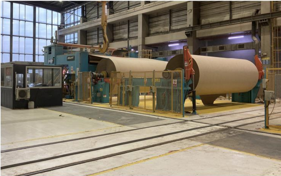
Şekil 4.10: Jumbo tampon sarımı ve bobin kesme.
