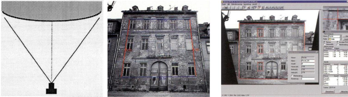
Şekil 2.6: Tek görüntü yöntemiyle makinenin konumlandırılması ve çekilen görüntünün düzeltilmesi (Turan, 2004).
