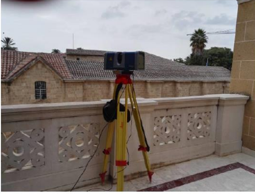
Şekil 3.9: Yapılan lazer tarama ve fotogrametrik ölçümler ve yapının BIM modelinin oluşturulması (Santagati, Papacharalambous, Sanfilippo, Bakirtzis, Laurini, & Hermon, 2019).
