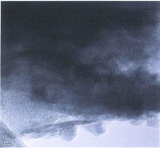
Şekil 3.34: Farklı çözücüler kullanılarak çözelti ortamında etkileştirme yöntemi ile hazırlanan a)PMMA/Al-MMT %2,5 (kloroform) b)PMMA/Al-MMT %2,5 (toluen) c)PMMA/Al-MMT %2,5 (THF) nanokompozitlerine ait TEM görüntüleri
