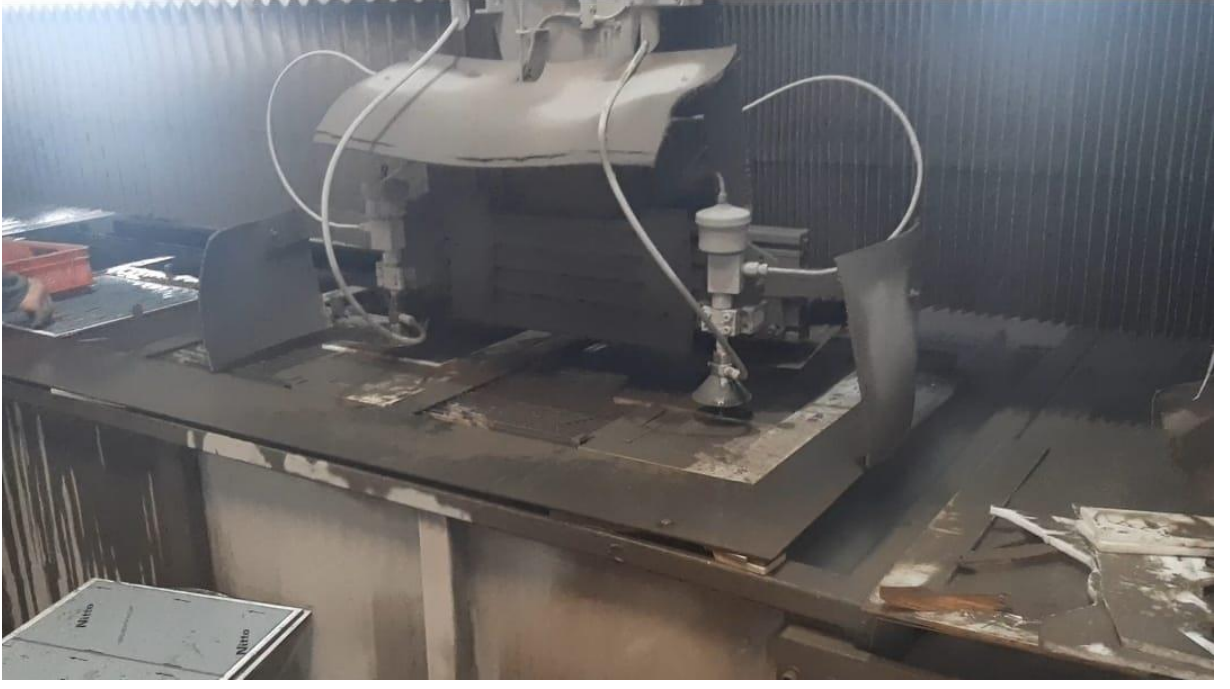
Şekil 4.4: Numunelerin kesiminde kullanılan su jeti kesim cihazı.
