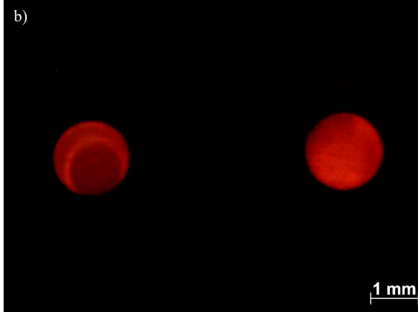
Şekil 5.13: Kontrol numunesine ait kesit görüntüsü a) Dijital mikroskop görüntüsü b) UV ışık altında dijital mikroskop görüntüsü.
