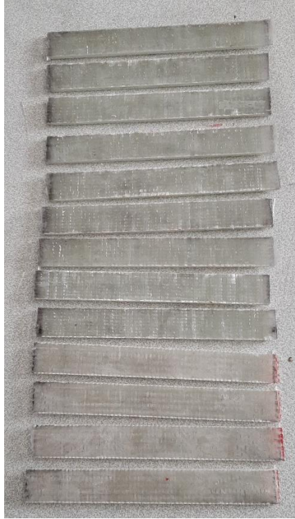
Şekil 4.5: Bir grup numunenin su jeti kesimden sonraki görüntüsü.
