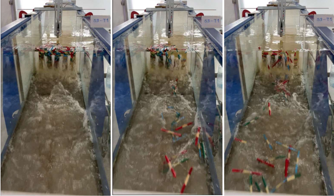
Şekil 4.27: Odunsu malzemenin Bent-1'in üzerinden aşması.
