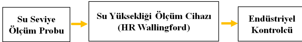
Şekil 4.23: Dalga kanalı su seviye ölçüm şeması
