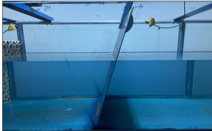
Şekil 4.14: Flap tür dalga üretici yapısı
