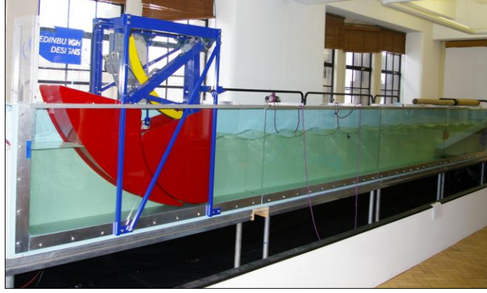
Şekil 2.2: Dikdörtgen kesitli dalga kanalı
