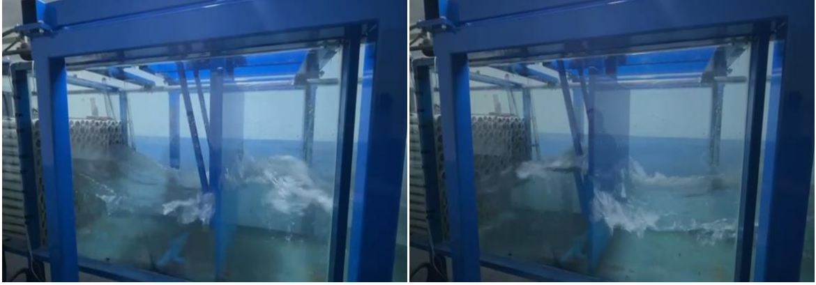
Şekil 4.20: Dalga kanalında PTWM ile dalga üretimi
