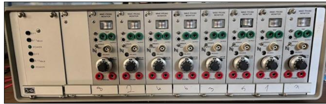
Şekil 4.24: Wallingford su seviye ölçüm sistemi
