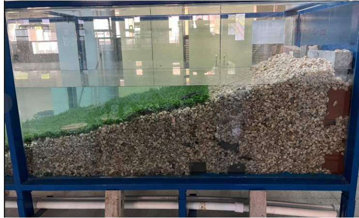
Şekil 4.22: Kıyı tip dalga sönümleyici yapısı
