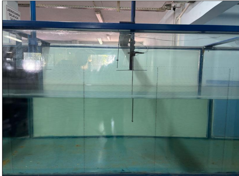
Şekil 4.26: Dalga ölçümü için fiziksel doğrulama yapısı
