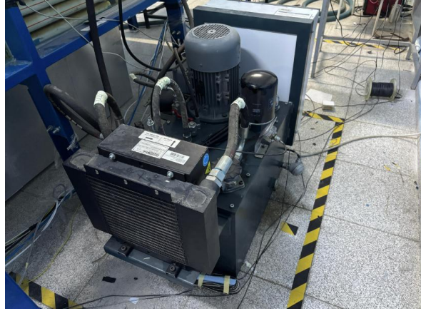
Şekil 4.29: Hidrolik güç ünitesi
