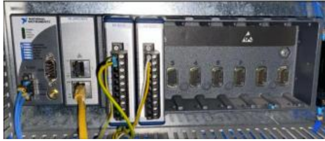
Şekil 4.5: CRIO-9074 ve modül kullanımı
