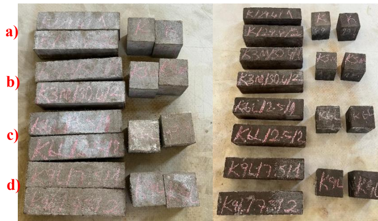
Şekil 4.55: Donma-çözülme öncesi ve sonrası numunelerin durumu a)K b)K3L c)K6L d)K9L e)5T f)5T3L g)5T6L h)5T9L i)10T j)10T3L k)10T6 l)10T9L serisi
