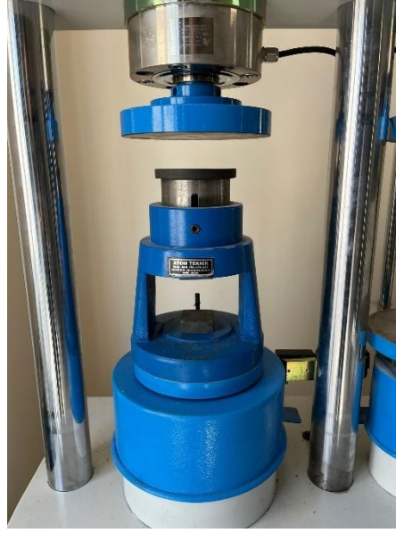
Şekil 3.8: Prizma numunelerin basınç dayanımının belirlenmesi için kullanılan kırma başlığı
