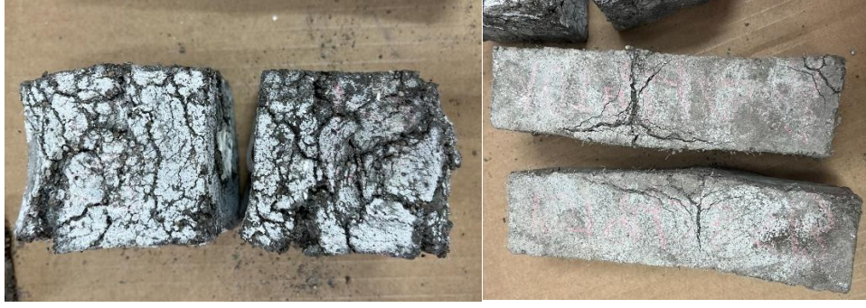
Şekil 4.89: 10T9L serisine 3 ay MgSO_4 çözeltisi etkisi
