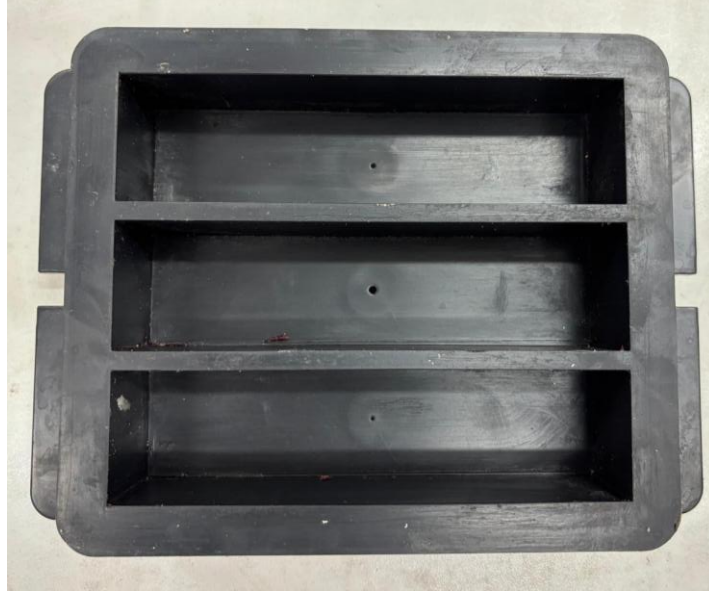
Şekil 3.6: 40x40x160 mm ebatındaki kalıplar
