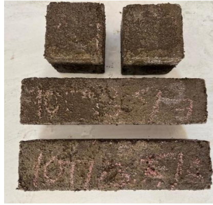
Şekil 4.90: 10T serisine 3 ay Na_2SO_4 çözeltisi etkisi
