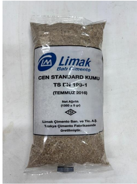
Şekil 3.3: Çalışma kapsamında kullanılan agrega
