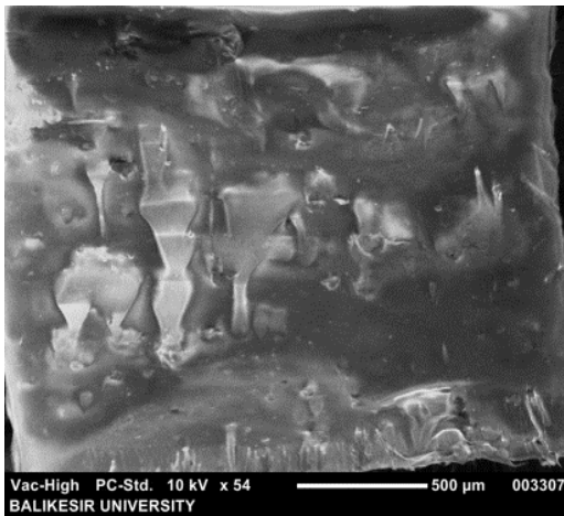
Şekil 3,29: a) %5 PE/3-CTAB-Silika filmin SEM görüntüsü, b) %5 PE/3-CTAB-Silika filminin dijital görüntüsü, c) %20 PE/3-CTAB-Silika filmin SEM görüntüsü, d) %30 PE/3-CTAB-Silika filmin SEM görüntüsü
