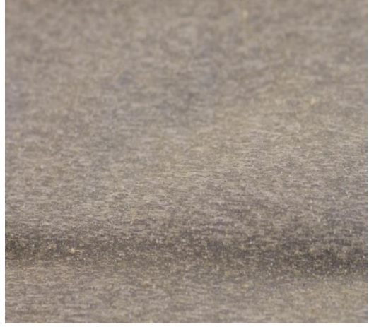
Şekil 3.32 (devamı): g) %40 PE/3-APTS-Diatomit filmin SEM görüntüsü, h) %40 PE/3-APTS-Diatomit filminin dijital görüntüsü
