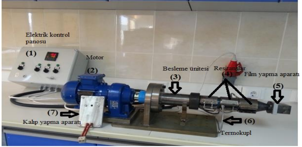
Şekil 2.6: Kompozit film sentezinde kullanılan ekstruder cihazı
