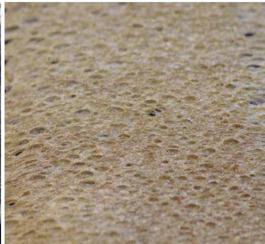
Şekil 3.34 (devamı): c) %20 PE/Benzoiklorür-Diatomit filmin SEM görüntüsü, d) %20 PE/Benzoiklorür-Diatomit filminin dijital görüntüsü, e) %30 PE/Benzoiklorür-Diatomit filmin SEM görüntüsü, f) %30 PE/Benzoiklorür-Diatomit filminin dijital görüntüsü, g) %40 PE/Benzoiklorür-Diatomit filmin SEM görüntüsü, h) %40 PE/Benzoiklorür-Diatomit filminin dijital görüntüsü
