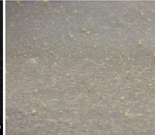
Şekil 3.23 (devamı): a) %5 PE/bentonit filmin SEM görüntüsü, b) %5 PE/bentonit filminin dijitalgörüntüsü c) %20 PE/bentonit filmin SEM görüntüsü, d) %20 PE/bentonit filminin dijital görüntüsü, e) %30 PE/bentonit filmin SEM görüntüsü, f) %30 PE/bentonit filminin dijital görüntüsü, g) %40 PE/bentonit filminin SEM görüntüsü, h) %40 PE/bentonit filminin dijitalgörüntüsü
