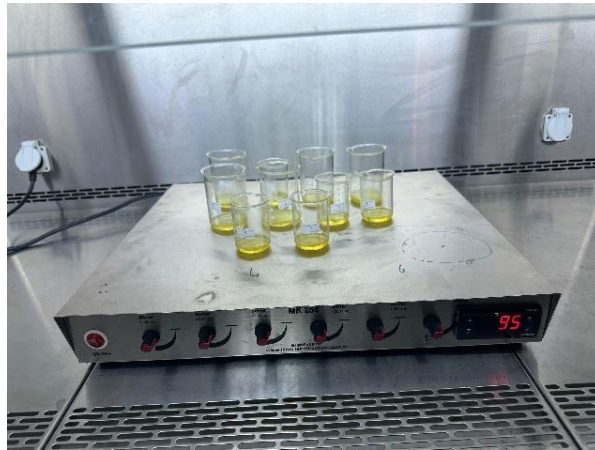
Şekil 3. 3. Serum örneklerinin mineralizasyonu için atmosferik basınçta ıslak kül sindirimi prosedürü.
