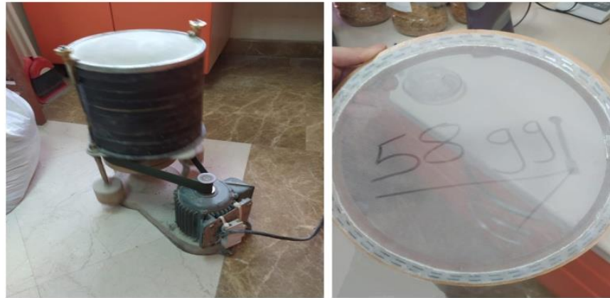
Şekil 3.8: Granülasyon analizi elekleri.
