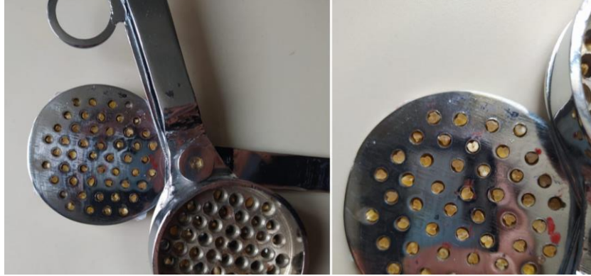
Şekil 3.4: Grobecker kesme aleti ile camsılık tayini.
