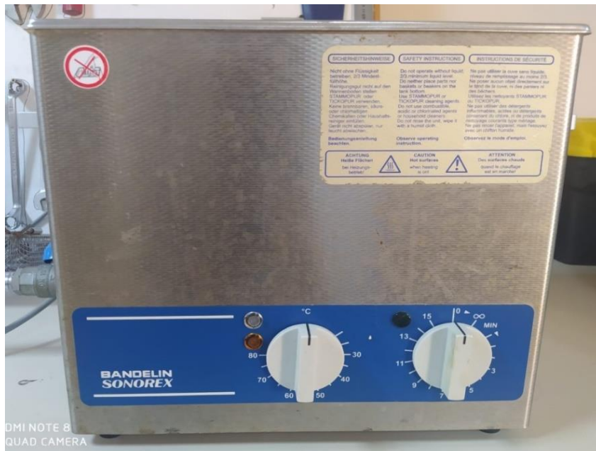
Şekil 3.1: Bandelin RK 510 H ultrasonik banyo.
