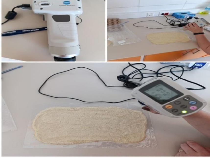
Şekil 3.5: Minolta CR 300 cihazı ile renk ölçümü.
