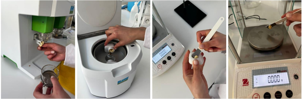
Şekil 3.6: Perten Glutomatic 2000 cihazı ile gluten ve gluten indeks ölçümü.
